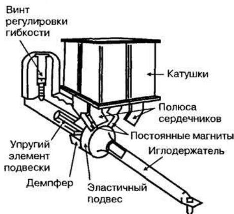
Рис. 1.8. Устройство ММ-головки
