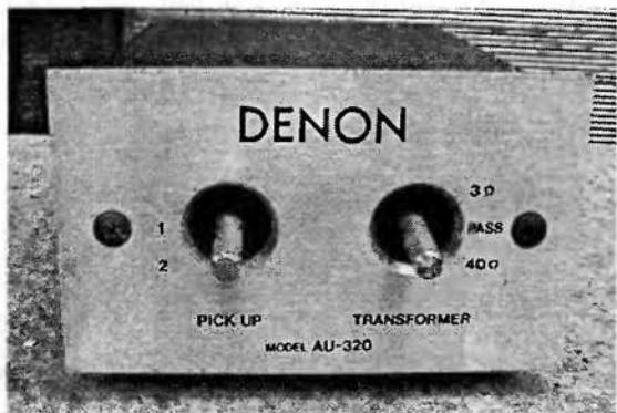
Рис. 4.5. Трансформатор DENON AU-320
