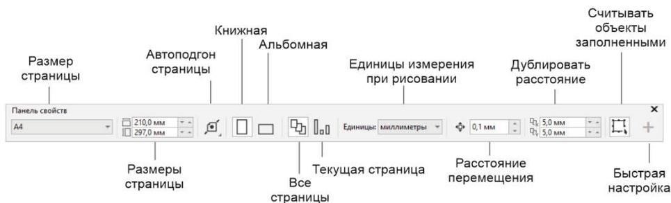
Рис. 1.7. Панель свойств инструмента **Указатель**
