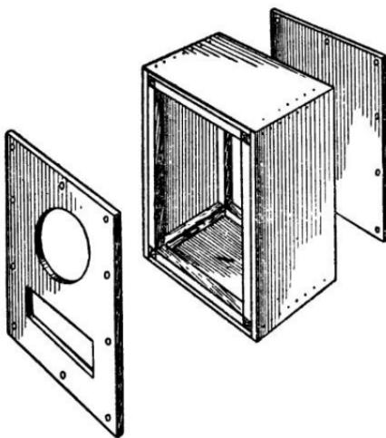
Рис. 38. Эскиз конструкции ящика для фазоинвертора.
