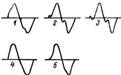
Рис. 15. Осциллограммы звукового давления громкоговорителя.
