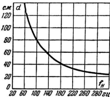
Рис. 2. График для определения размеров акустического экрана.
