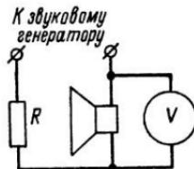
Рис. 21. Схема для измерения частотной характеристики полного сопротивления громкоговорителя.
