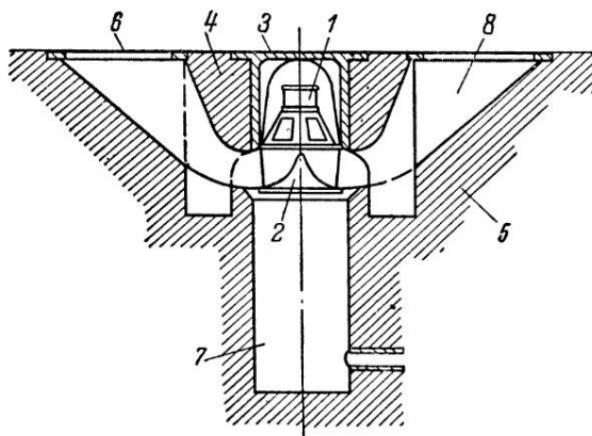
Рис. 28. Разрез конструкции „земляного“ громкоговорителя.
