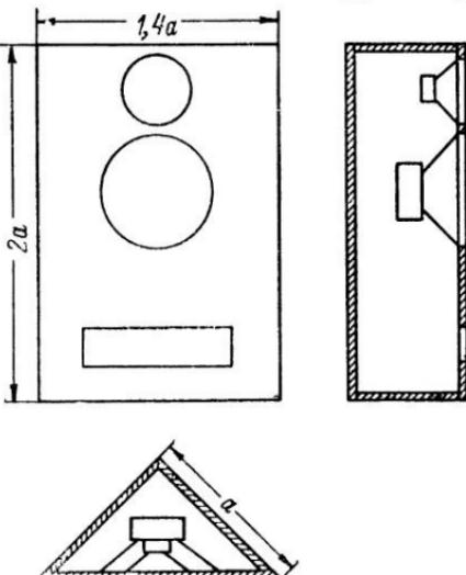
Рис. 19. Конструкция и размеры призмовидного фазоинвертора, предназначенного для размещения в углу комнаты.
