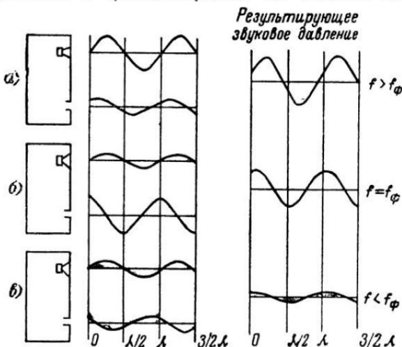
Рис. 13. Действие фазоинвертора.
