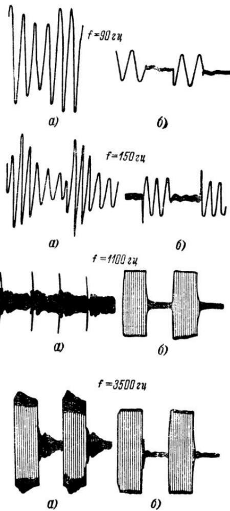
Рис. 10. Воспроизведение громкоговорителями прямоугольных импульсов частотой 90, 150, 1 100 и 3 500 гц.
