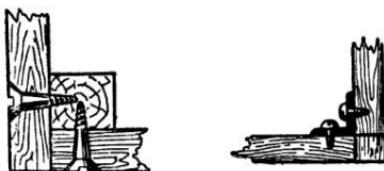
Рис. 37. Способы соединения панелей.
