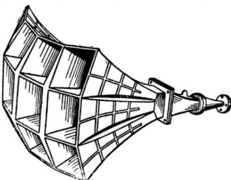
Рис. 33. Многоячейковый сферический рупор.
