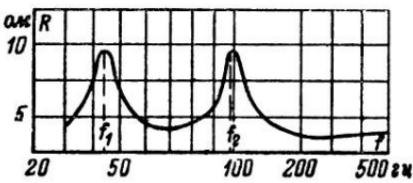
Рис. 14. Частотная характеристика полного сопротивления громкоговорителя в фазоинверторе
