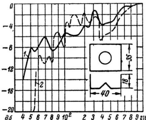
Рис. 6. Частотные характеристики громкоговорителя в ящике объемом 25  $\text{dm}^3$ .
