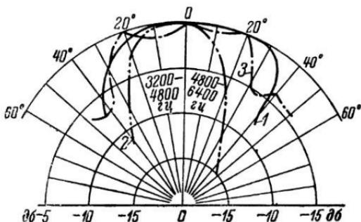
Рис. 34. Характеристики направленности высокочастотного громкоговорителя 30А-3.
