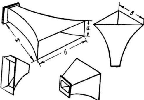
Рис. 25. Экспоненциальные рупоры различной конфигурации.
