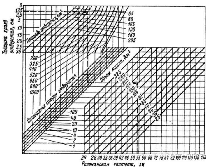
Рис. 20. Номограмма для расчета объема ящика фазоинвертора.
