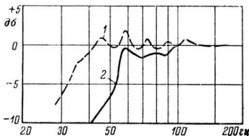
Рис. 16. Частотные характеристики громкоговорителя в фазоинверторах различных объемов.
