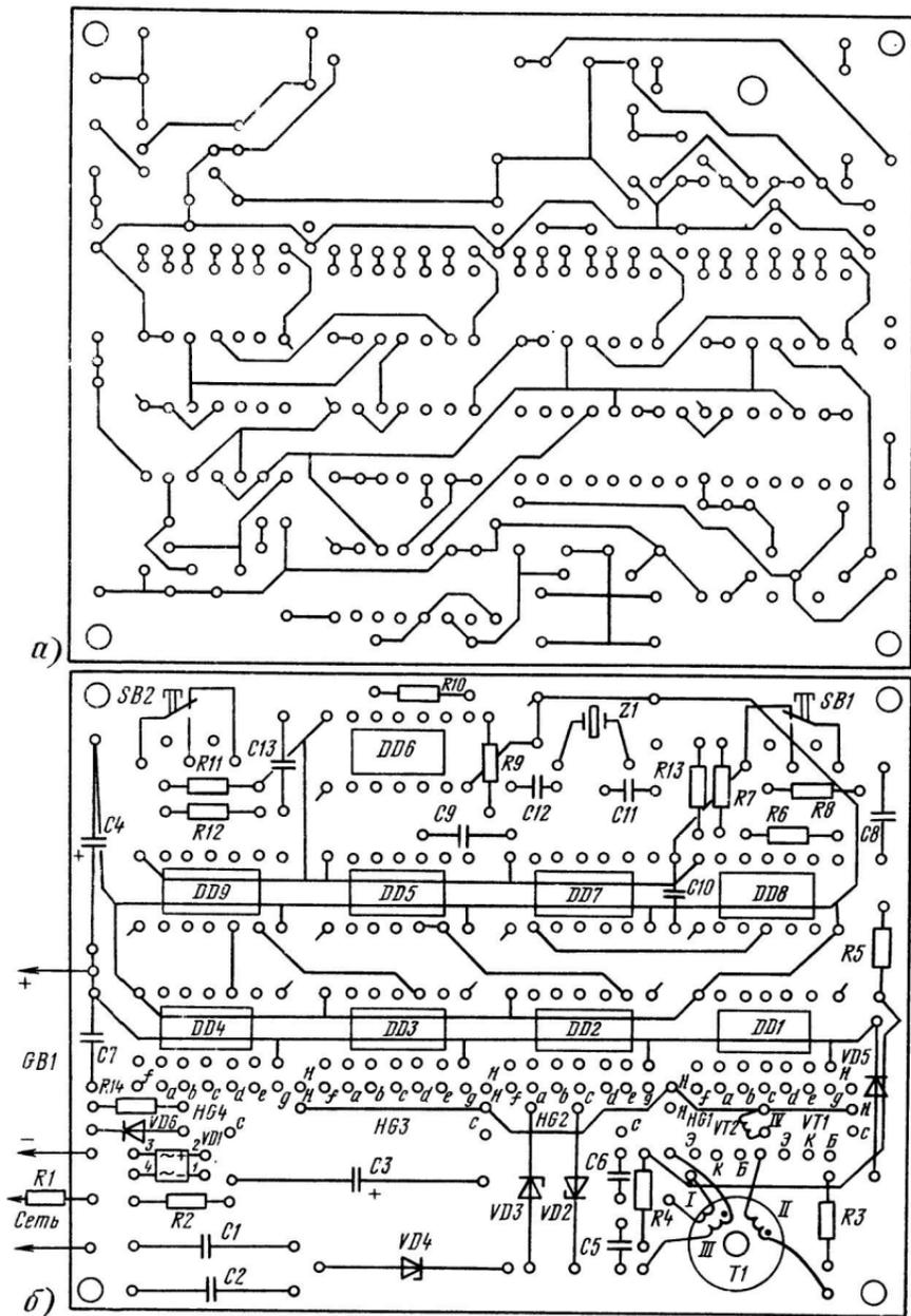
**Рис. 3. Печатная плата часов:**
