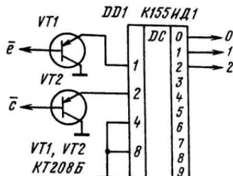
Рис. 22. Преобразователь кода десятков часов на микросхеме K155ИД1
