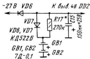
Рис. 41. Подключение резервной батареи питания
