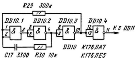
Рис. 10. Генератор для схемы рис. 9
