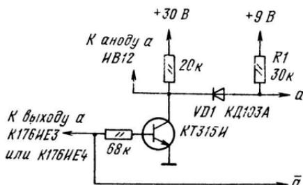
Рис. 20. Подключение преобразователей к ключам на p-n-p транзисторах
