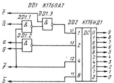
Рис. 19. Преобразователь кода единиц минут и часов
