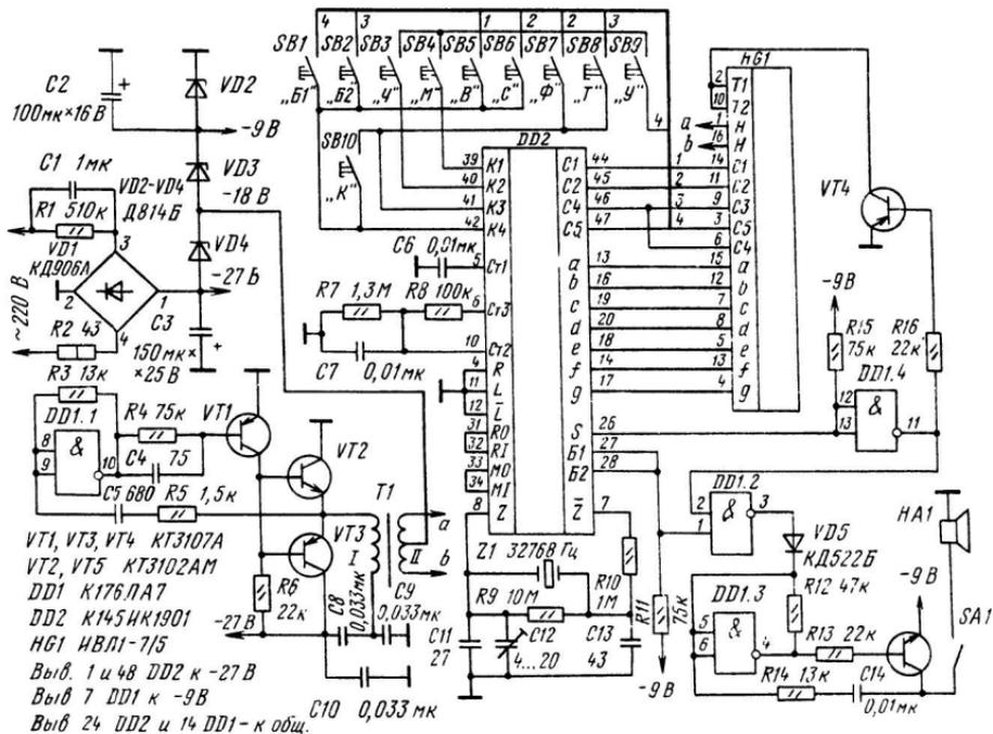
Рис. 38. Часы на микросхеме K145HK1901
