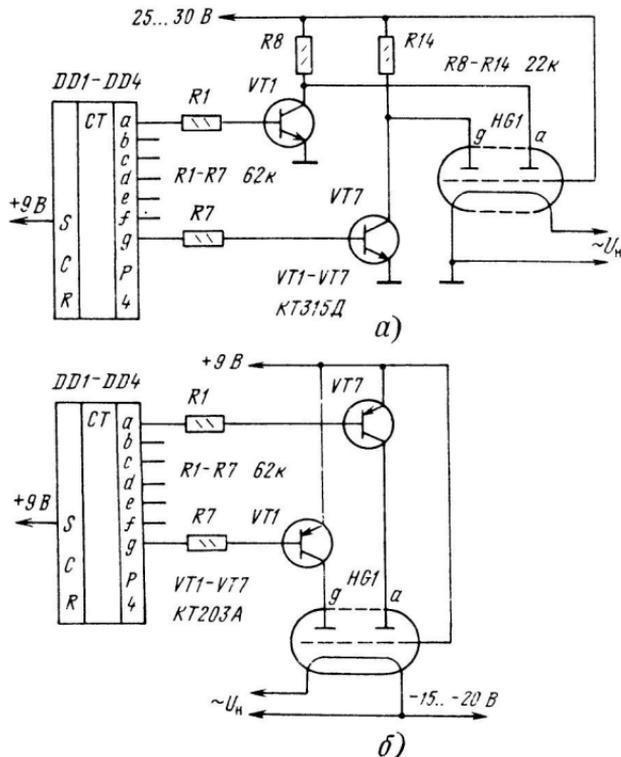
Рис. 5. Согласование микросхем К176ИЕ3 и К176ИЕ4 с вакуумными люминесцентными индикаторами:
