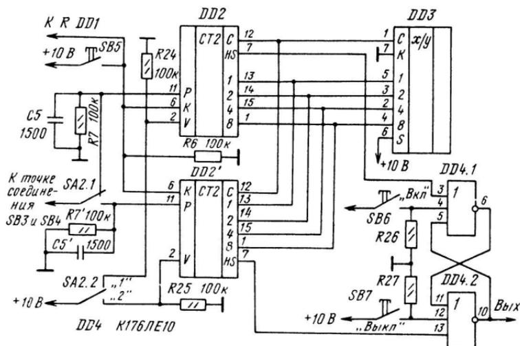
Рис. 35. Часы с двумя будильниками
