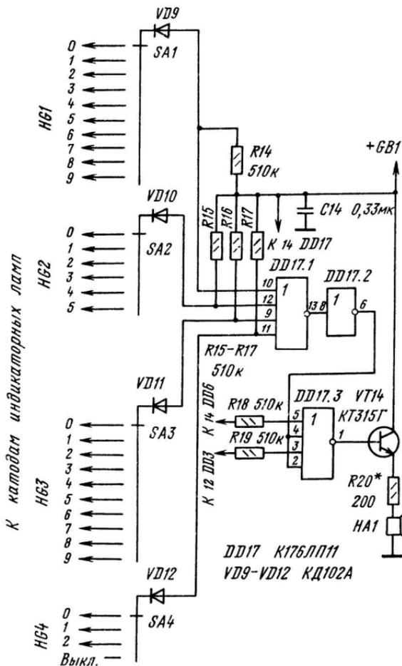
Рис. 16. Будильник для часов с газоразрядными индикаторами
