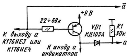
Рис. 21. Подключение преобразователей к ключам на р-п-р транзисторах
