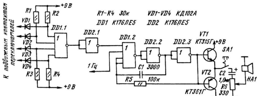
Рис. 24. Подключение звукового сигнала к преобразователям на микросхемах K155ИД1
