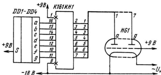
Рис. 7. Согласование с помощью микросхемы К161КН1
