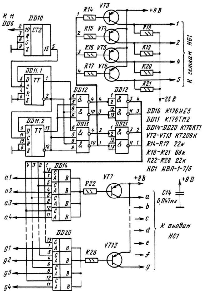
Рис. 9. Подключения индикатора ИВЛ1-7/5
