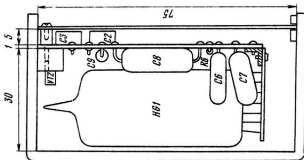
Рис. 15. Конструкция часов
