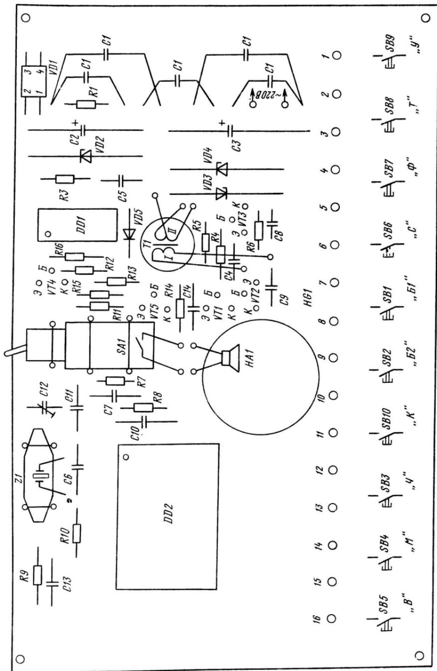
Рис. 40. Расстановка элементов на плате
