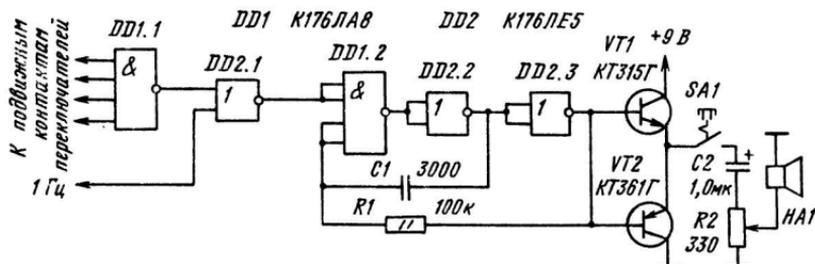
Рис. 23. Подключение звукового сигнала к преобразователям на микросхемах K176ИД1
