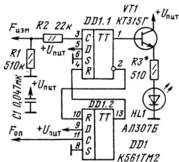
Рис. 44. Прибор для настройки часов
