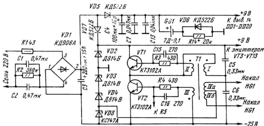
Рис. 11. Блок питания часов с индикатором ИВЛ1-7/5
