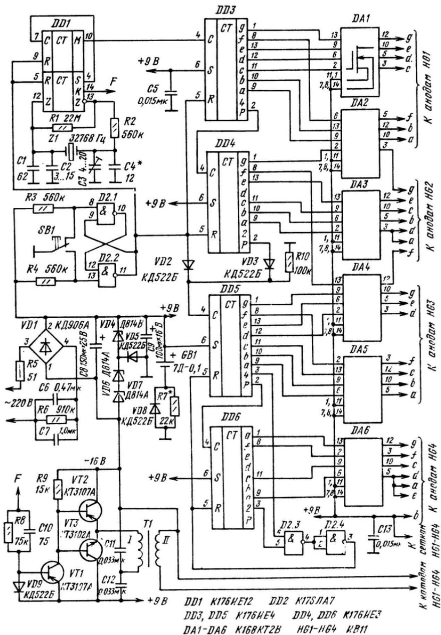
Рис. 12. Часы с генератором на микросхеме K176HE12
