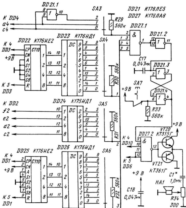
Рис. 28. Полная схема будильника
