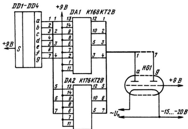
Рис. 6. Согласование с помощью микросхем К168КТ2В
