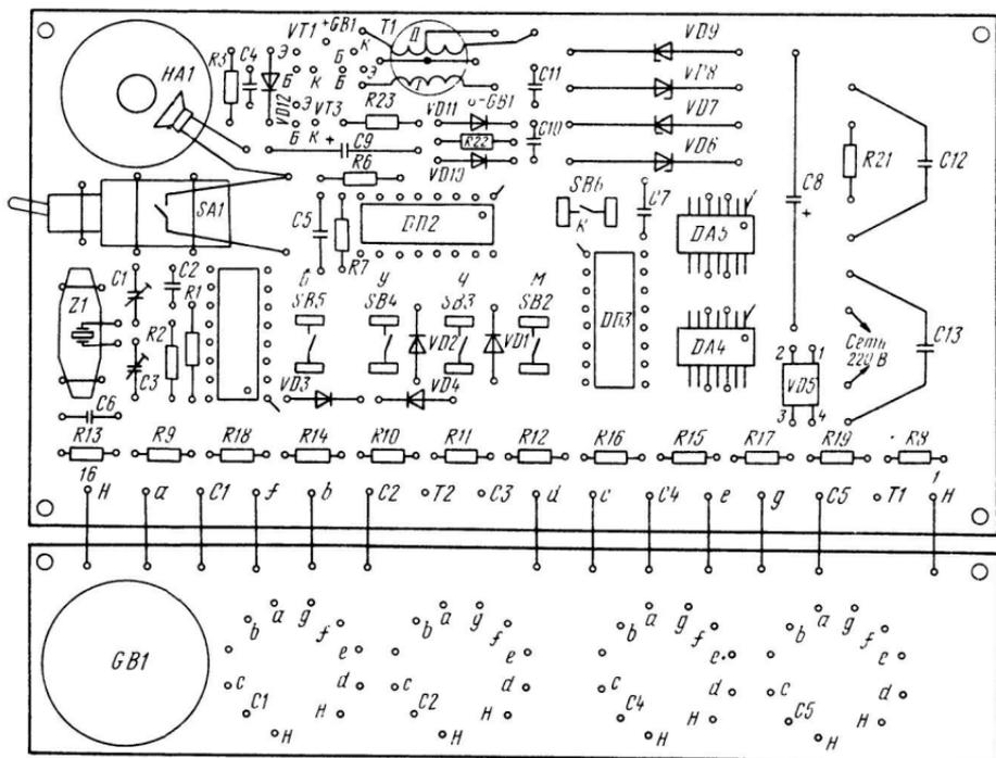
Рис. 34. Расстановка элементов часов-будильника
