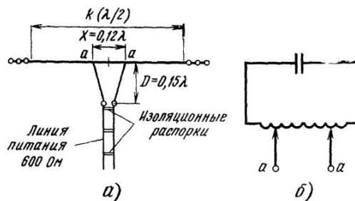
Рис. 7.6. Шунтовая схема питания полуволнового вибратора (а) и ее упрощенная эквивалентная схема (б)
