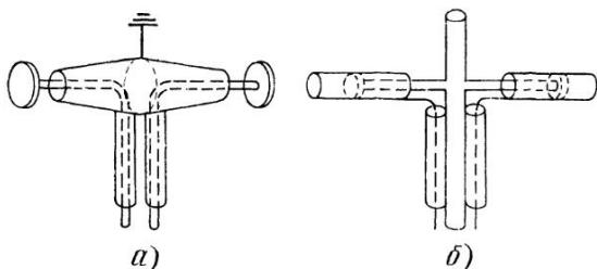
Рис. 6.3. Схемы широкополосных симметричных вибраторов, применявшимся в передающих телевизионных антенах:
