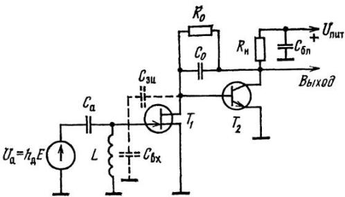
Рис. 5.7 Упрощенная схема активной автомобильной антенны АА-301
