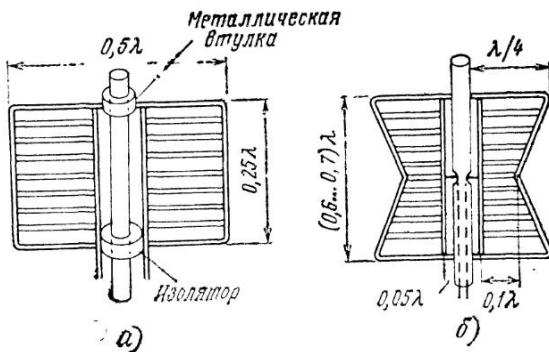
Рис. 6.4. Плоскостные вибраторы:
