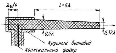
Рис 10.11. Поперечное сечение стержневой диэлектрической антенны длиной 6 длин волн
