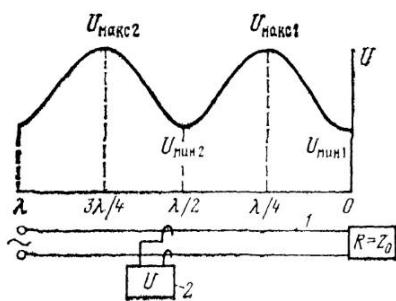
Рис. 11.1. Измерение коэффициента полезного действия и коэффициента бегущей волны в фидерной линии:
