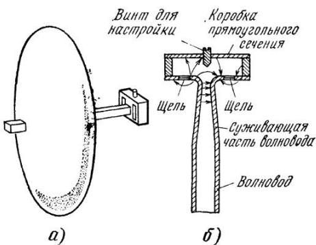
Рис. 8.15. Возбуждение параболоида двухщелевым облучателем обратного излучения:
