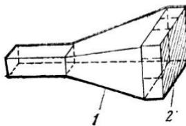
Рис. 10.6. Проходной поляризатор в рупорном облучателе:
