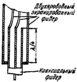
Рис. 2.12. Дроссельное симметрирующее устройство (типа «четвертьволновый стакан»)
