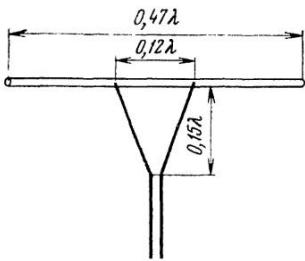
Рис. 6.8. Неразрезной полуволновый симметричный вибратор параллельного питания
