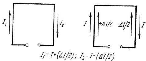
Рис. 4.23. Прохождение токов в рамке при нарушении симметрии
