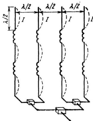
Рис. 4.13. Секция направленной антенны
