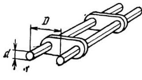
Рис. 2.3. Воздушная двухпроводная (неэкранированная) линия
