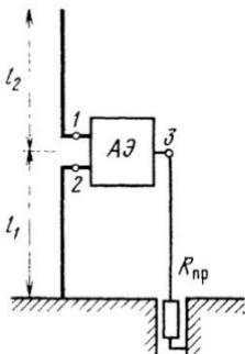
Рис. 5.3. Схема включения антеннного усилителя в середину штыревой заземленной антенны
