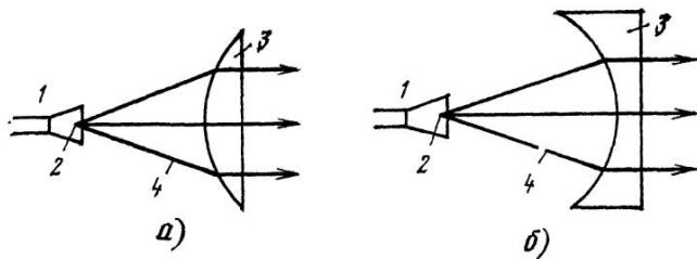
Рис. 8.6. Заземляющая (а) и ускоряющая (б) линзы:
