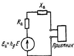
Рис. 3.11. Эквивалентная схема приемной антенны
