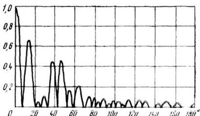
Рис. 4.15. Диаграмма направленности в горизонтальной плоскости ромбической антенны
