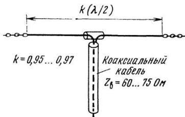
Рис. 7.9. Схема питания полу-
