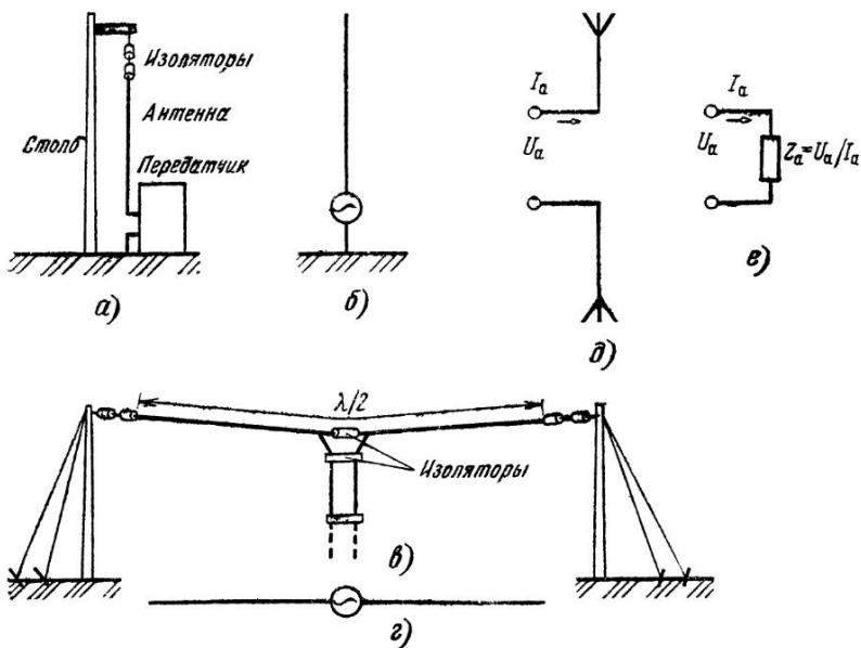
Рис. 3.5 ВERTикальная заземленная антенна (а) и ее электрическая схема (б); симметричный горизонтальный вибратор — диполь (в) и его электрическая схема (г); условное обозначение проволочной антенны (д) и ее эквивалентная схема (е)
