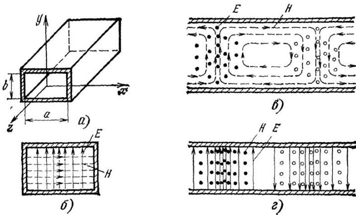
Рис. 2.7. Прямоугольный волновод (а) и структура поля в нем при волне типа  $H_{10}$ : в плоскостях  $xy$  (б);  $xz$  (в);  $yz$  (г)
