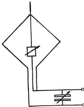
Рис. 4.25. Антennaя система для однонаправленного приема
