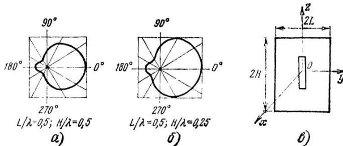
Рис. 8.23. Диаграмма направленности полуволновой щели (одностороннего излучения) в прямоугольном плоском экране:
