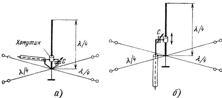
Рис. 7.13. Антenna «GP» с шунтовым питанием с параллельным (а) и последовательным (б) подключением подстроичного конденсатора
