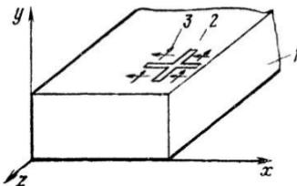
Рис. 10.4. Крестообразная щель на широкой стенке волновода, излучающая вращающуюся поляризацию:
