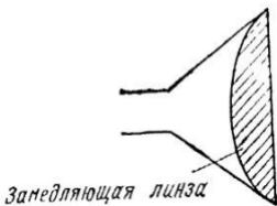
Рис. 8.5. Рупор с диэлектрической фазовыравнивающей линзой
