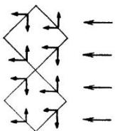
Рис. 6.12. Принцип действия зигзагообразной антенны
