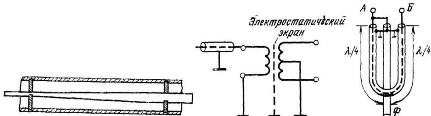
Рис. 2.9. Эскиз плавного перехода для согласования двух коаксиальных линий с разными волновыми сопротивлениями
