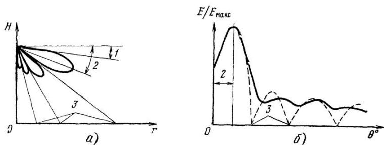
Рис. 6.1. Диаграмма направленности передающей антенны в вертикальной плоскости:
