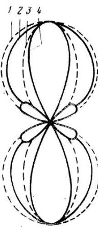
Рис. 4.4. Диаграммы направленности симметричных вибраторов различной длины:
