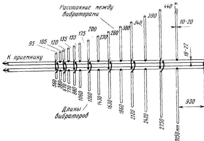
Рис. 6.18. Расположение и размеры вибраторов в логопериодической антенне, предназначеннной для приема телевизионного вещания на каналах 1—12
