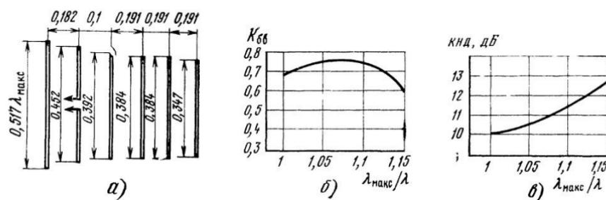
Рис. 6.16. Шестизлементная антenna типа «волновой канал»:
