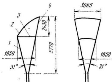
Рис. 8.16. Рупорно-параболическая антенна для волны  $\lambda=8$  см:
