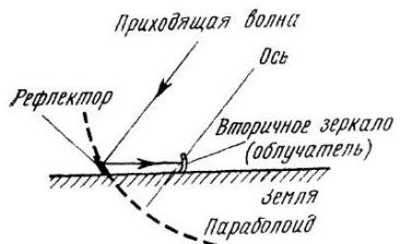
Рис. 8.18. Антенна переменного профиля, работающая в режиме приема внеземного излучения
