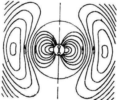
Рис 3.2 Картинка силовых линий электрического поля вблизи диполя
