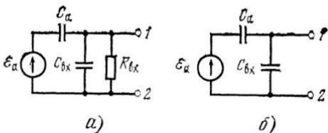
Рис. 5.5 Эквивалентная схема антенны и входного сопротивления усилителя
