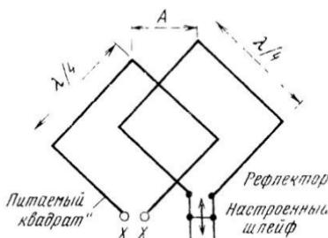
тены (60 ... 70 Ом для антенны с рефлектором), что примерно соответствует волновому сопротивлению коаксиального кабеля. Пассивный рефлектор располагается на расстоянии 0,1 ... 0,2λ от питаемого «квадрата» и настраивается с помощью короткозамкнутого шлейфа переменной длины на максимум излучения в направлении, перпендикулярном плоскости антенны. При указанных на рисунке размерах поле излучения имеет горизонтальную поляризацию.
