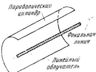
преобразует ее в плоскую волну 4, т. е. расходящийся пучок лучей преобразуется в параллельный, чем и достигается формирование острой диаграммы направленности 6.
