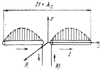
Рис. 4.3. Распределение тока на симметричных вибраторах:
