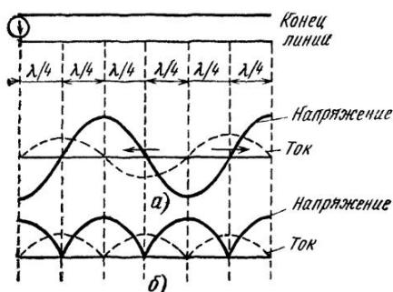
Рис. 2.1. Стационарные волны тока и напряжения в разомкнутой на конце линии
