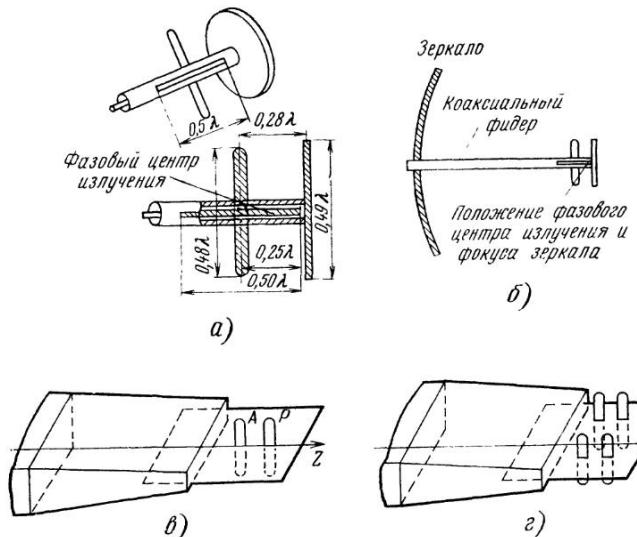
Рис. 8.13. Облучатели параболических антенн
