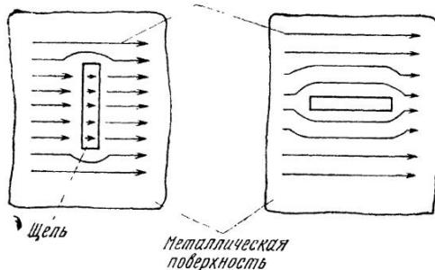
Рис. 8.20. Прямолинейная щель в плоском экране
