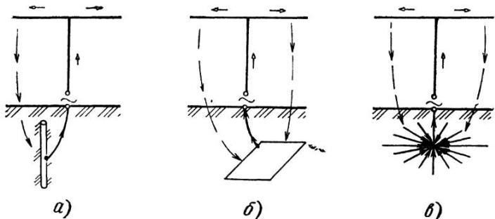
Рис. 4.20. Схема Т-образной передающей антенны с заземлением:
