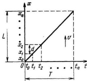
Запоминая принятые в каждый момент  $t_n$  сигналы, а затем обрабатывая их (например, складывая для получения суммарной диаграммы направленности), получаем сигнал на выходе, соответствующий сигналу реальной антенной решетки с раскрывом  $L$  и координатами  $x_n$  ее элементов.
