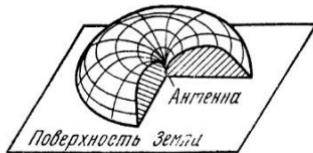
Влияние земной поверхности на характеристику направленности горизонтального вибратора можно учесть по методу зеркальных изображений. Горизонтальный вибратор, подвешенный на высоте  $h$  над земной поверхностью, следует заменить системой из двух параллельных вибраторов, находящихся на расстоянии  $2h$  с токами в противоположных фазах. Направленное действие такой антенной системы рассматривается ниже.
