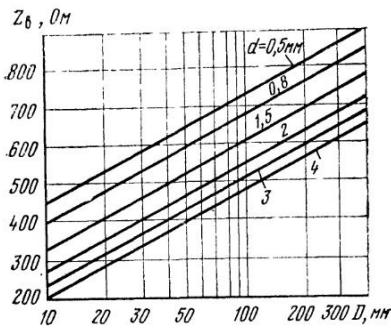
Рис. 2.5. Графики для расчета волновых сопротивлений двухпроводных (симметричных) воздушных линий
