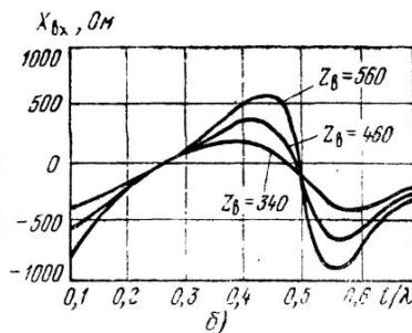
Рис. 4.5. Зависимость входного сопротивления симметричного вибратора от его длины (в долях длины волны):
