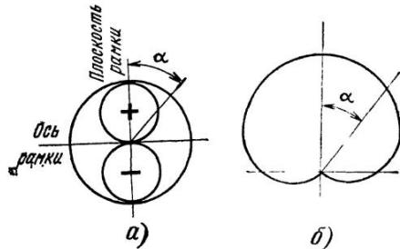
Рис. 4.26. Диаграмма направленности антеннной системы из рамки и вертикального штыря (кардиоидная диаграмма направленности):
