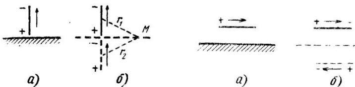
Рис. 3.12. Вертикальная антenna над хорошо проводящей почвой (а) и ее электрический эквивалент (б)
