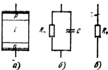
Рис. 2.13. Диод типа *p-i-n* и его эквивалентные схемы
