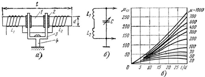
Рис. 7.1. Магнитная антenna (а), схема включения ее во входной контур приемника (б) и значения  $\mu_{\text{cr}}=f(l/d)$  (в)
