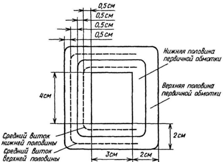
Рис.52. Разрез каркаса выходного трансформатора
