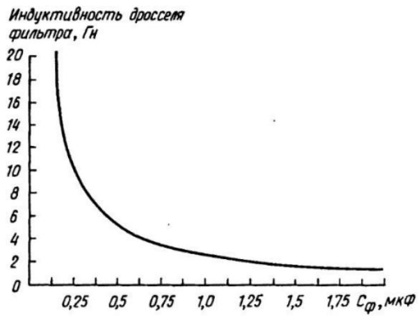
Рис.22. График для определения резонансной емкости фильтра
