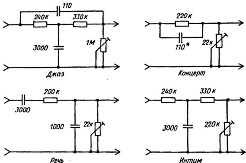
Рис.13. Схемы, формирующие фиксированные частотные характеристики
