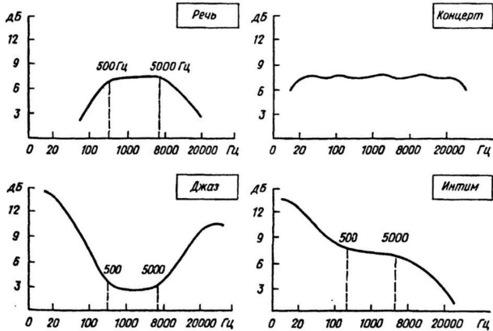
Рис.12. Частотные характеристики фиксированных режимов кланг-регистра
