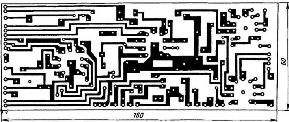
Рис.47. Заготовка печатной платы одного канала стереоусилителя
