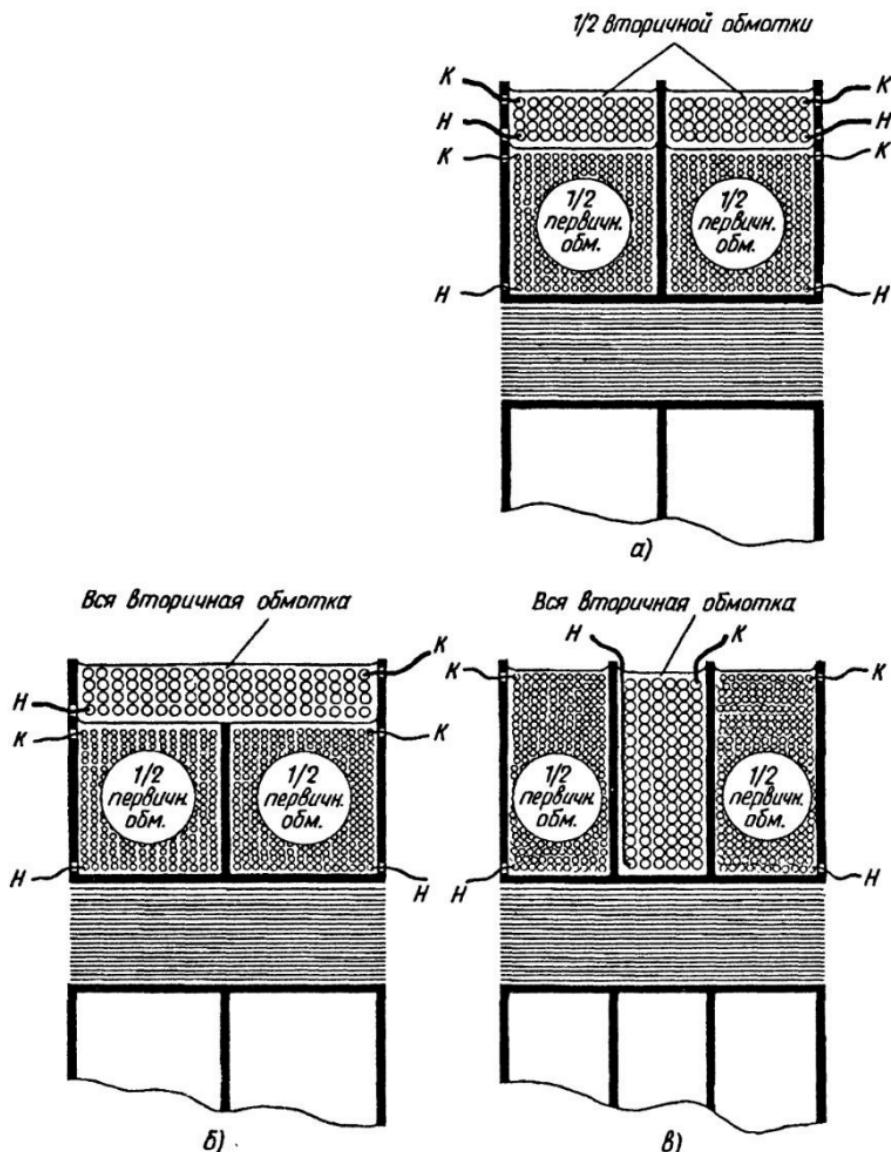
Рис.53. Три варианта секционированной намотки выходного трансформатора
