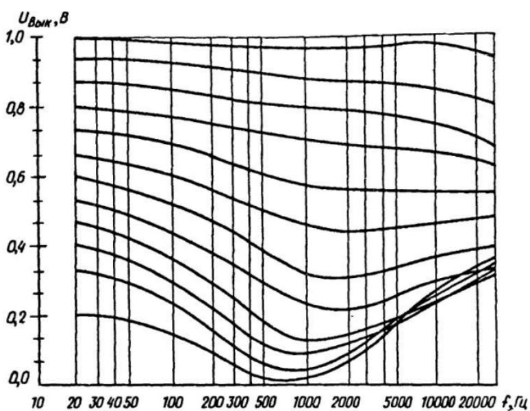
Рис.31. Семейство характеристик тонкомпенсации регулятора громкости
