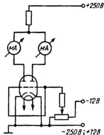
Рис.43. Схема контроля идентичности триодов в сдвоенных лампах
