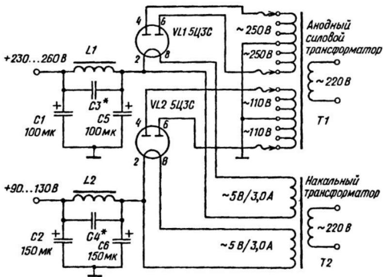
Рис.29. Вариант схемы анодных выпрямителей с использованием кенотронов
