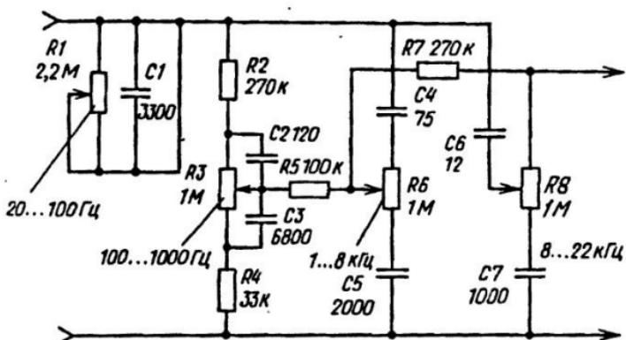
Рис.14. Схема плавных регуляторов тембра
