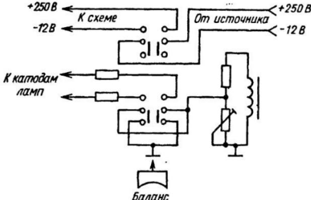
чечным переключателем типа П2К без фиксации нажатого положения с четырьмя коммутирующими группами. В этом случае из схемы можно исключить реле. Схема коммутации этого варианта приведена на рис. 26. Если же радиолюбитель будет собирать схему по основному варианту, то в качестве реле можно использовать РЭС-60 (паспорт 4.569.438), РЭС-9 (паспорт 4.524.201), РЭС-6 (паспорт 0.452.106) или любое другое, желательно малогабаритное, с двумя группами переключения и рабочим напряжением 10...12 В.
