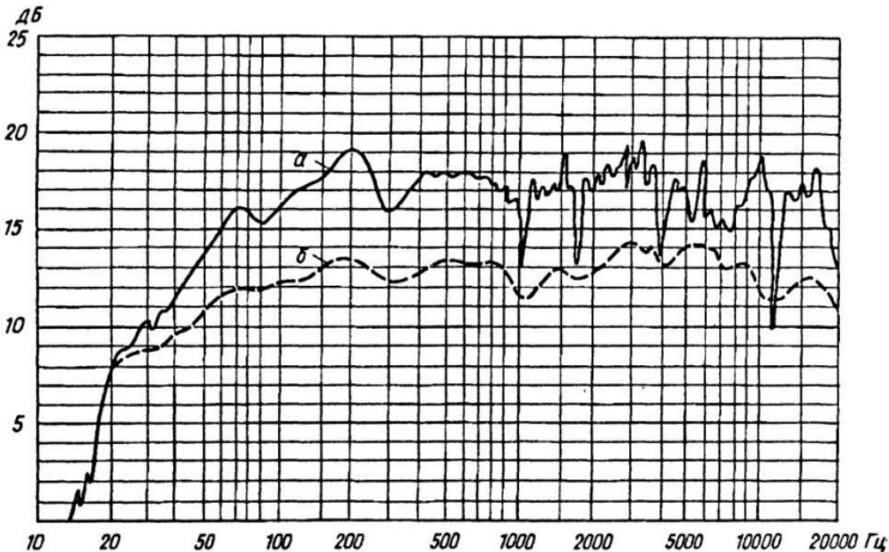
Рис.56. Частотная характеристика реальной акустической системы совместно с усилителем, охваченные общей цепью обратной связи:
