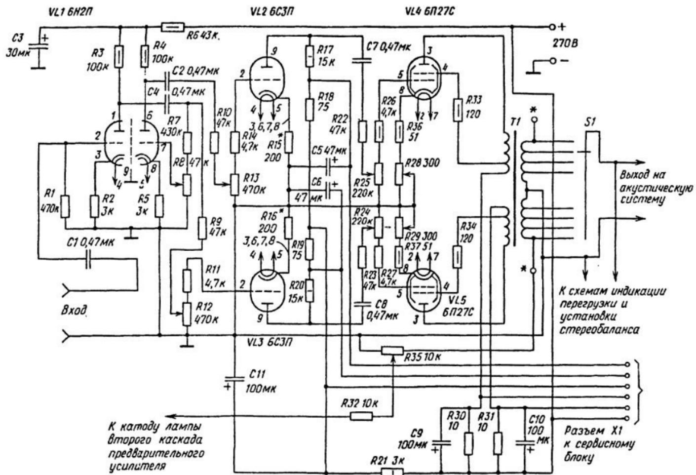
Рис. 6. Принципиальная схема окончательного усилителя
