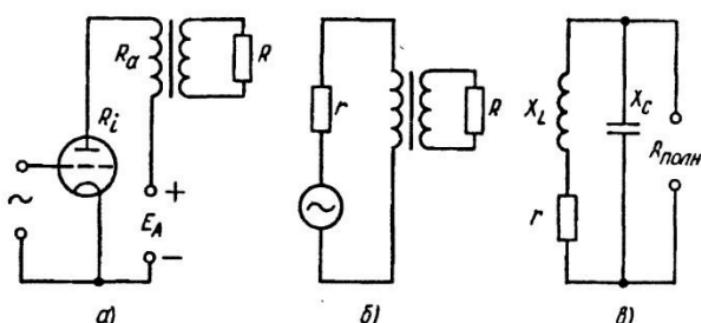
Рис.50. Оконечный трансформаторный каскад на триоде:
