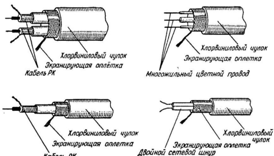
Рис.40. Конструкция соединительных шлангов (длинных линий) для сигнальных коммуникаций аудиокомплекса
