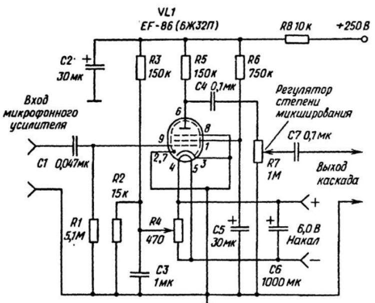
Рис.35. Принципиальная схема микрофонного усилительного каскада
