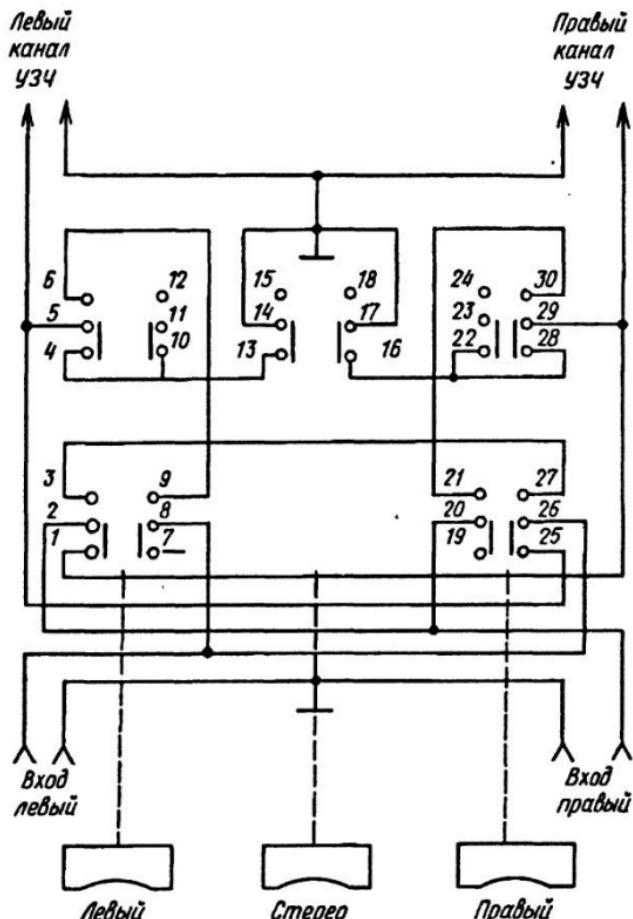
Рис.20. Схема коммутатора входных сигналов и режимов "Моно-стерео"
