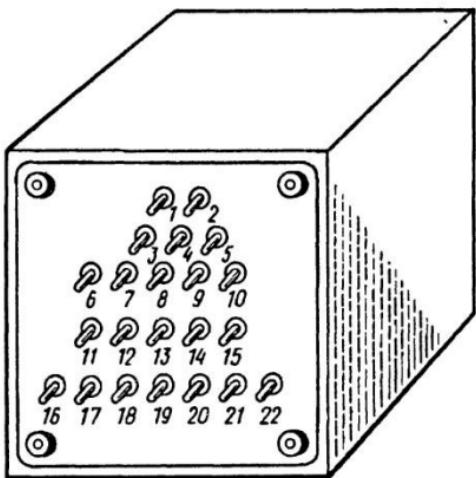
В конструкциях автора выходные трансформаторы после сборки и влагозащитной пропитки церезином помещались в прямоугольные алюминиевые экраны-стаканы, а выводы всех обмоток распивались на гетинаксовую контактную платформу, закрывавшую экран снизу. Внешний вид такого трансформатора показан на рис. 55.
