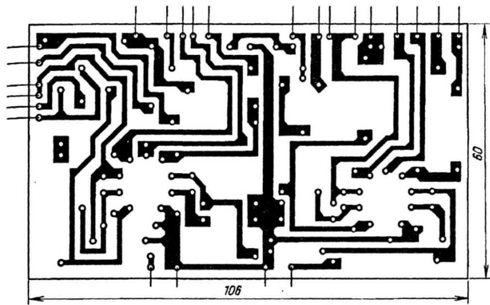
Рис. 8. Печатная плата предварительного усилителя
