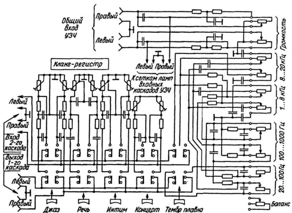
Рис.16. Электрическая схема блока-кланг-регистра
