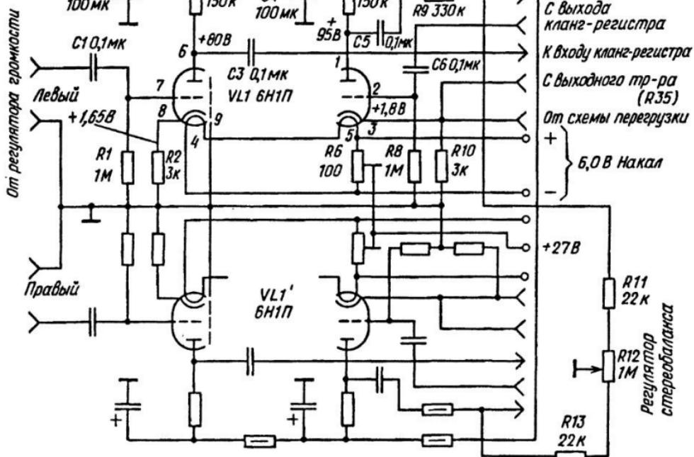
Рис. 7. Схема предварительного двухкаскадного усилителя напряжения
