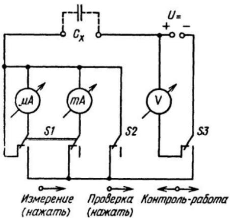
Рис. 3. Схема устройства для измерения токов утечки конденсаторов
