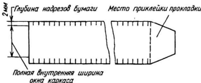
Рис.54. Заготовка изоляционной бумажной прокладки
