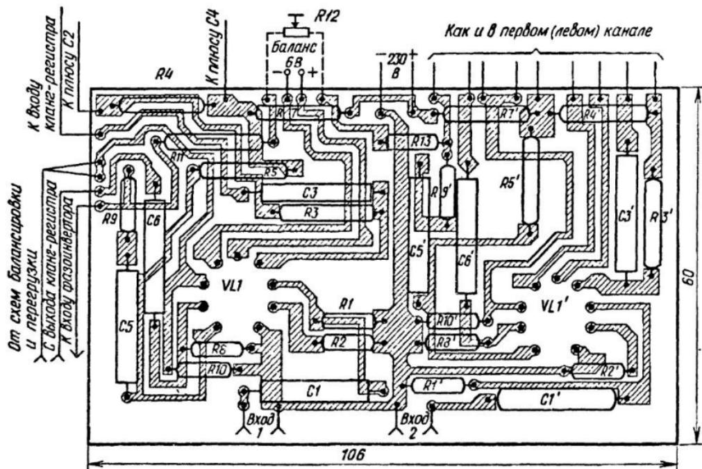
Рис. 9. Расположение деталей на печатной плате
