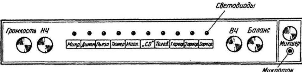
Рис.37. Панель управления предварительного усилителя
