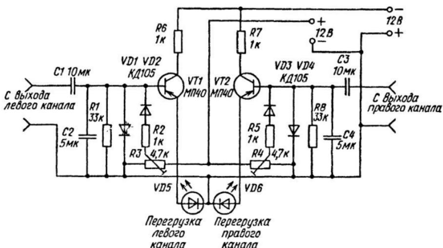
Рис.27. Схема узла индикации перегрузки усилителя
