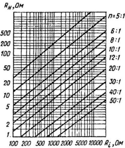
Рис.51. График для определения коэффициента трансформации выходного трансформатора
