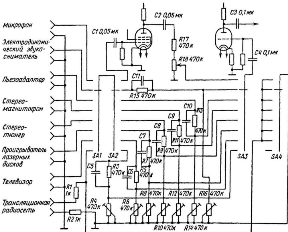
Рис.33. Схема входного коммутатора сигналов
