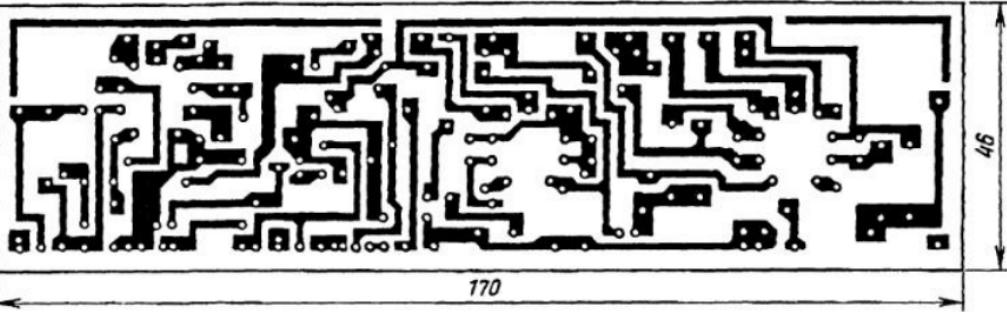
Рис.39. Размещение деталей на плате усилителя
