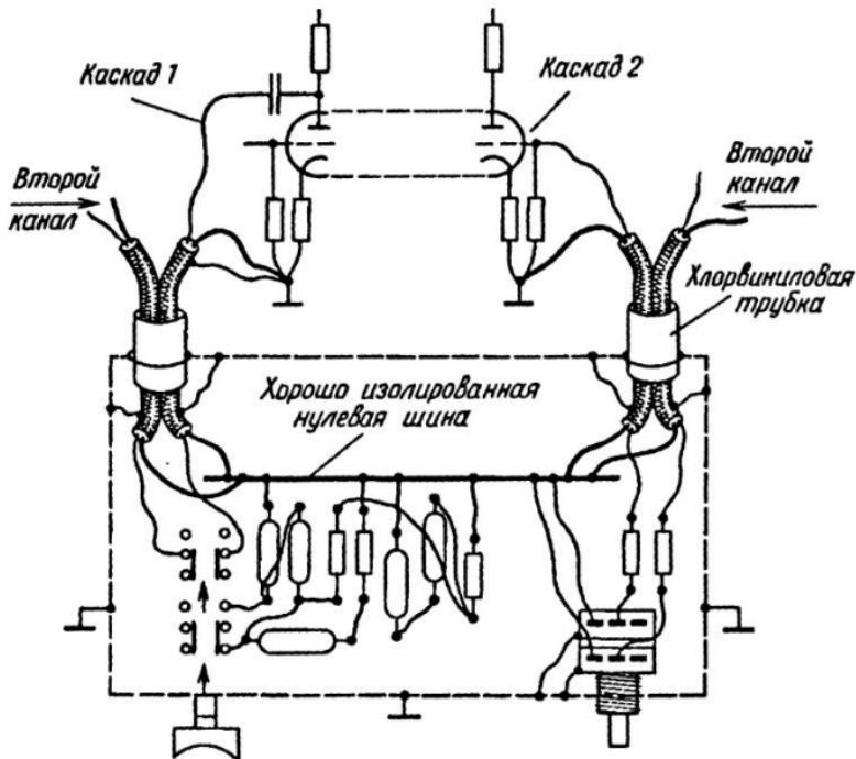
Рис.18. Правильная распайка нулевых проводов и экранирующих оплеток внутри функциональных блоков
