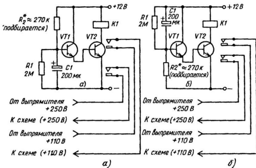
Рис.30. Схема задержки включения анодного напряжения:
