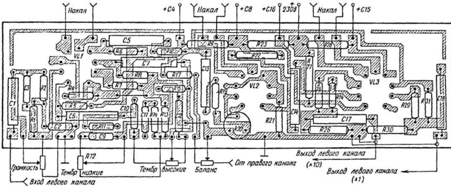
Приведем один из множества возможных вариантов, при котором усилитель выполнен как автономный узел управления всеми аппаратами аудиокомплекса. В отличие от описанного ранее усилителя высшего класса, данный усилитель достаточно компактный и легкий. В связи с этим пришлось отказаться от горизонтального размещения переключателя-коммутатора на передней лицевой панели, поскольку при нажатии на кнопки-клавиши переключателя возможно перемещение по столу всего блока усилителя.
