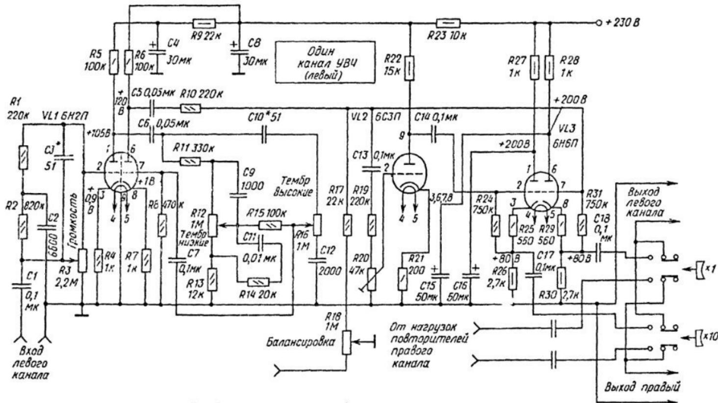
Рис.34. Принципиальная схема предварительного УЗЧ
