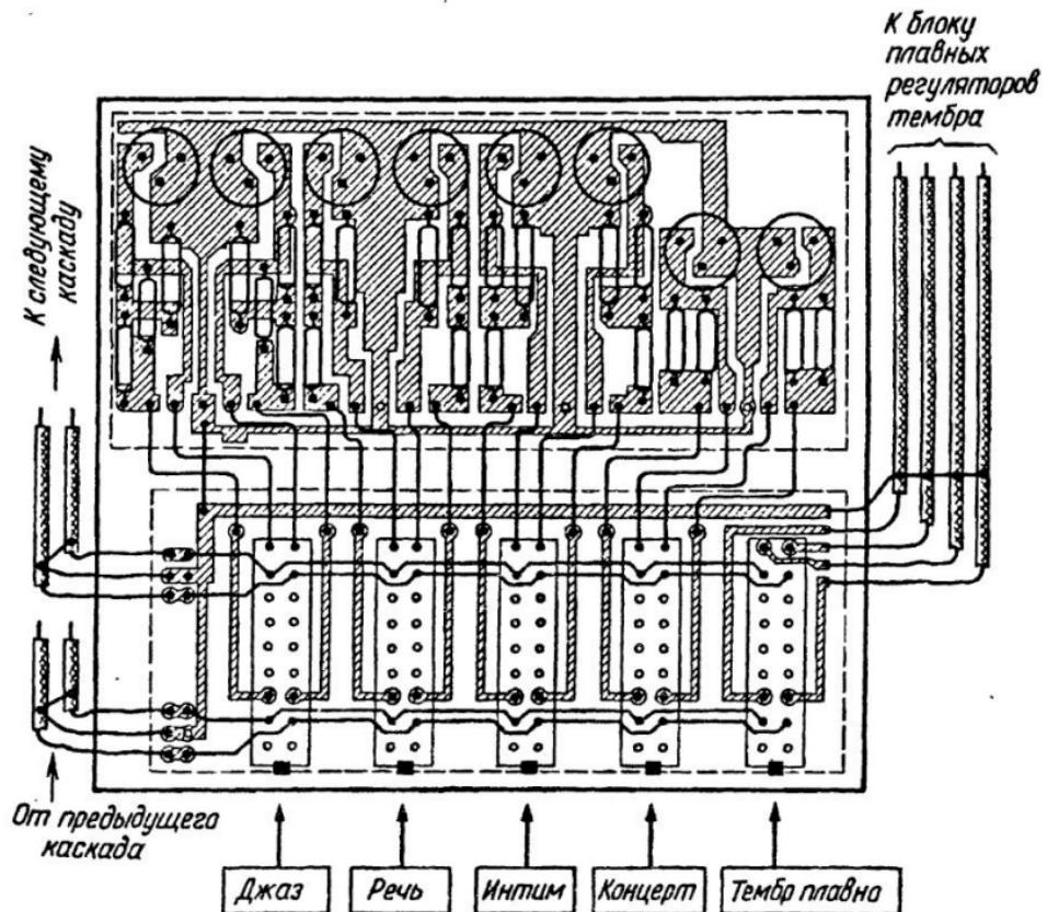
Рис.15. Печатная плата блока кланг-регистра и распайка переключателя
