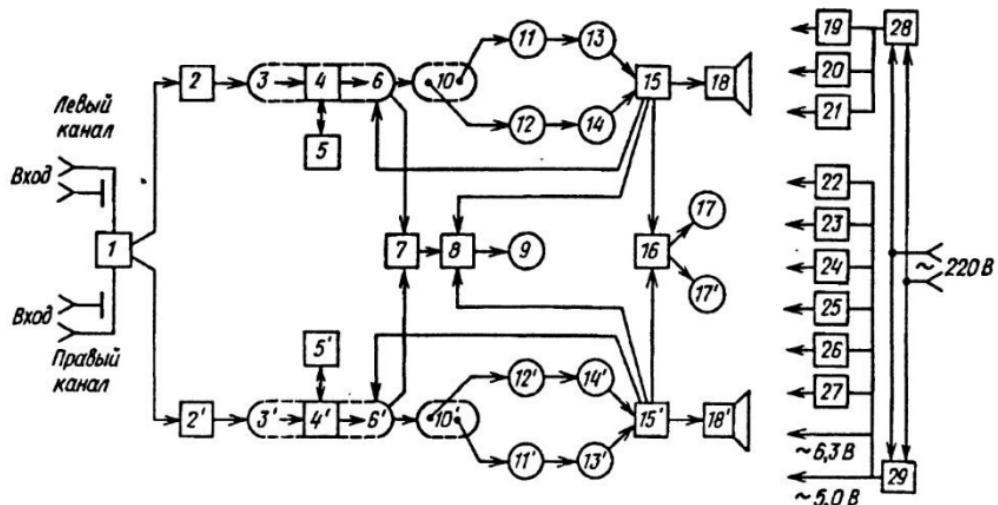
Рис. 5. Структурная схема стереоусилителя высшего класса
