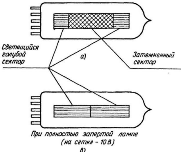
Рис.25. Вид светящегося экрана индикатора стереобаланса в разных режимах
