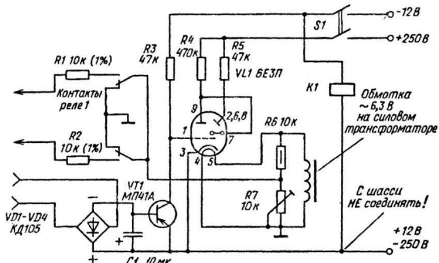
Рис.24. Схема узла индикации точного стереобаланса
