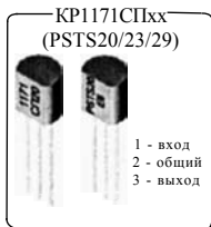
Рис. 7.3. Буквенно-цифровая маркировка ИМС стабилизаторов
