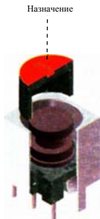
Рис 3.3. Цветовая маркировка контурных катушек приёмно-передающих трактов
