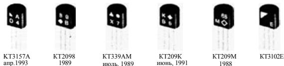
Рис. 6.21. Вид буквенно-символьной маркировки отечественных транзисторов
