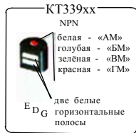
Рис. 6.10. Виды символично-цветовой маркировки отечественных транзисторов в корпусах КТ-26 (ТО-92)
