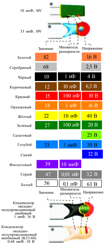
Рис. 2.10. Цветовая маркировка электролитических конденсаторов
