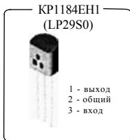
Рис. 7.3. Буквенно-цифровая маркировка ИМС стабилизаторов
