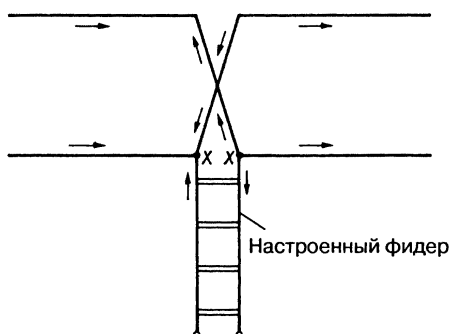
Рис. 13.13. Синфазная горизонтальная антенна с настроенным фидером
