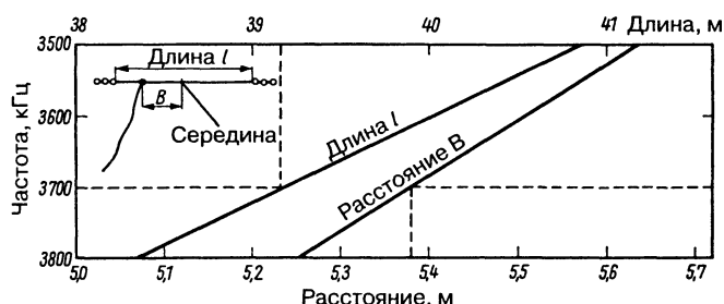
Рис. 10.12. Частотные зависимости геометрической длины l антенны Виндома для 80-метрового диапазона и расстояния B между точкой подключения фидера и центром излучателя
