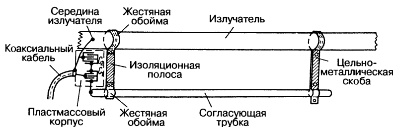
Рис. 6.7. Рекомендуемое устройство согласующего звена
