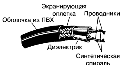
Рис. 5.11. Экранированная двухпроводная линия
