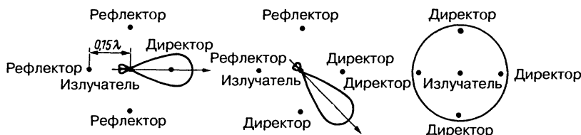
Рис. 19.80. Антенна QH-Beam: схематичный вид сверху и горизонтальная диаграмма направленности
