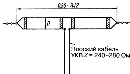
Рис. 10.4. Петлевой вибратор в качестве КВ антенны
