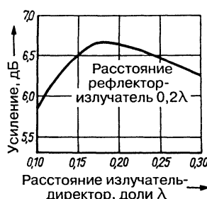
Рис. 16.6. Зависимость усиления трехэлементной антенны от расстояния между излучателем и директором при постоянном расстоянии излучатель-рефлектор 0,2\lambda
