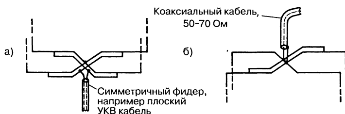
Рис. 15.18 Питание и возбуждение «швейцарского квадрата»: а – сдвоенное Т-образное согласование и питание; б – сдвоенное гамма-образное согласование и питание
