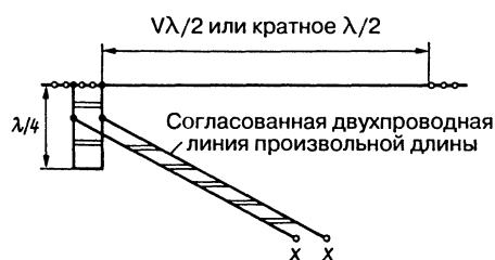
Рис. 10.8. Излучатель с концевым питанием через ненастроенный фидер
