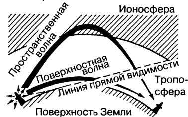
Рис. 2.3. Пути распространения поверхностной и пространственной электромагнитных волн
