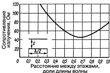
Рис. 13.7. Сопротивление излучения в пучности тока каждого из двух синфазно возбуждаемых параллельных вибраторов в зависимости от межэтажного промежутка S
