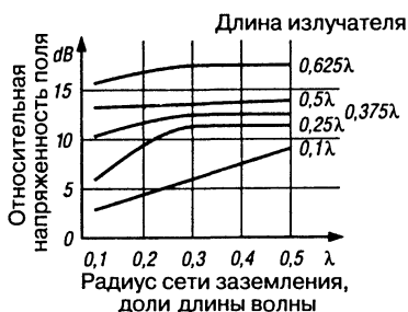
Рис. 19.5. Зависимость относительной напряженности поля от радиуса сети заземления для вертикальных излучателей разной длины
