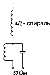
Рис. 19.85. Принципиальная схема согласования КВ спиральной антенны
