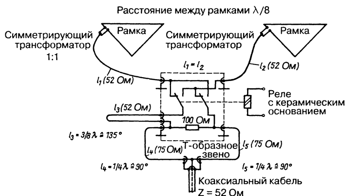
Рис. 19.82. Схема возбуждения двухэлементной антенны Delta-Loop на 3,5 МГц с переключением ориентации главного луча и распределителем мощности
