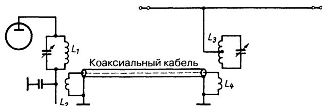
Рис. 10.13. Антенна Виндома с линией-связкой
