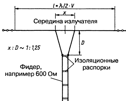
Рис. 6.1. Согласующий дельта-трансформатор
