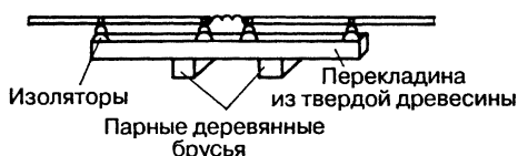
Рис. 18.13. Вариант крепления элементов антенны G4ZU
