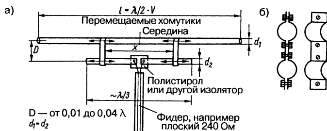
Рис. 6.2. Согласующий Т-трансформатор: а – рекомендуемая компоновка; б – зажимные скобы
