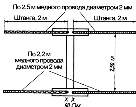
Рис. 17.7. Укороченный излучатель 10-метрового диапазона на удилищах
