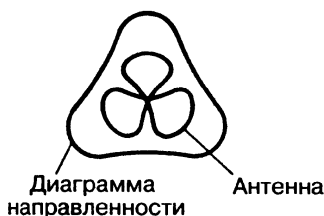
Рис. 25.28. Диаграмма направленности одиночной антенны Big Wheel
