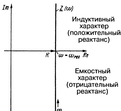
Рис. 32.8. Амплитудно-фазовая характеристика импеданса последовательного колебательного контура как функция частоты
