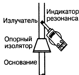
Рис. 31.38. Применение индикатора резонанса с вертикальной антенной
