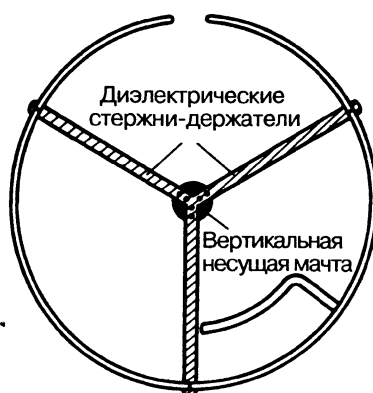
Рис. 25.17. Рациональное крепление кольцевого вибратора
