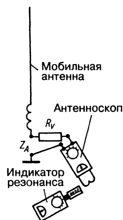
Рис. 31.44. Схема измерений предельно низких входных сопротивлений
