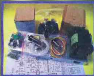
"Двухтактный оконечный усилитель на 6Н23П и 6П43П"
