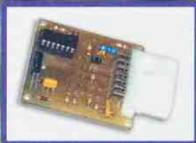
"Блок зажигания — регулятор угла 03 на микроконтроллере PIC16F676"
