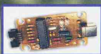
"USB программатор микроконтроллеров AVR и AT89S, совместимый с AVR910"
