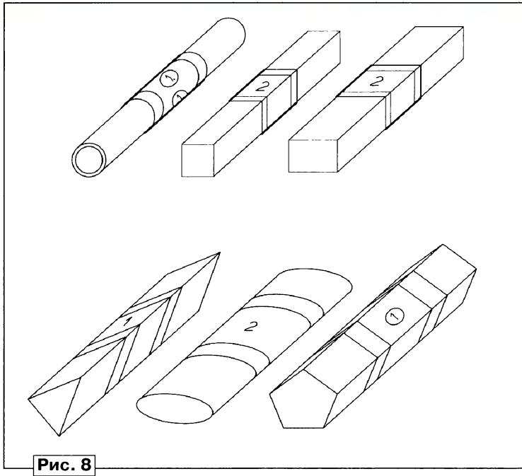
его диаметр. При этом полезная длина бумажной основы этикетки для нанесения обозначения составляет  $L_{\text{пол}} = \pi D$ . На ней должны быть нанесены знаки, символы, рисунки и т. д., таким образом, чтобы они были читаемы и их можно было видеть со всех сторон маркируемого изделия. Оставшаяся длина предназначена для начального закрепления этикетки на маркируемом изделии. Ширину В этикетки выбирают исходя из размеров символов обозначения для их лучшей читаемости.
