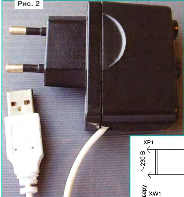
новить гнёзда для подключения сетевой вилки телевизора (**рис. 2**). Так получится вилка-выключатель. Можно применить и накладную сетевую розетку (получится розетка-выключатель), закрепив её на стене или другом удобном месте. Найти такую розетку, внутри корпуса которой можно разместить реле, нетрудно. Конденсатор C1 — пле-
