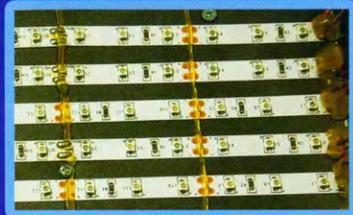
Светодиодная ультрафиолетовая лампа
