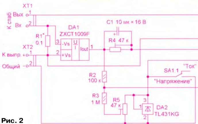
переключатель SA1.2. В эту же точку с резистора R5 через резистор R3 поступает компенсирующее напряжение минусовой полярности. При отсутствии выходного тока БП резистором R5 устанавливают нулевые показания индикатора вольтметра EK-2501. В режиме измерения напряжения стабилизатор на микросхеме DA2 закорочен контактами переключателя SA1.1.
