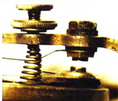
мас Холл, Чарльз Чабок и Честер Бразерс. Только в 1860 г. The L. G. Tilleyson Co. начала коммерческое производство телеграфной техники. В том же году главный инженер Western Union Джордж М. Феллс изобрёл пружинный регулятор жёсткости (рис. 2), ставший основной регулировкой любого ключа.
