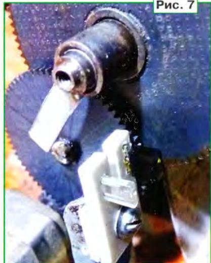
Элементы оптопары (излучающий диод и чувствительный элемент) должны иметь оптические окна как можно меньших размеров и расположенные с минимальным зазором одно напротив другого. Это обеспечит наиболее чёткое срабатывание датчиков.
