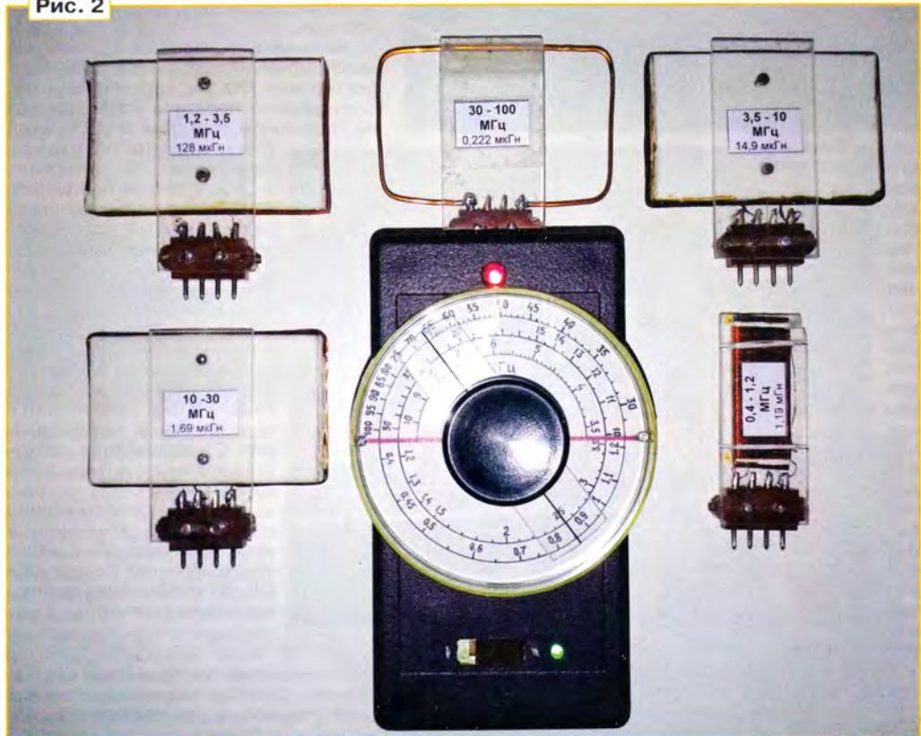
Сменные катушки диапазонов II–IV (рис. 2) выполнены в виде прямоугольных рамочных антенн на каркасах из органического стекла размерами 45×70 мм. Катушка диапазона I (там же) намотана виток к витку на стержне из феррита с магнитной проницаемостью 600 размерами 16×4×46 мм. Намоточные данные сменных катушек приведены в таблице. Все они намотаны проводом ПЭВ-2 разного диаметра и подключаются к прибору с помощью четырёхконтактных разъёмов.
