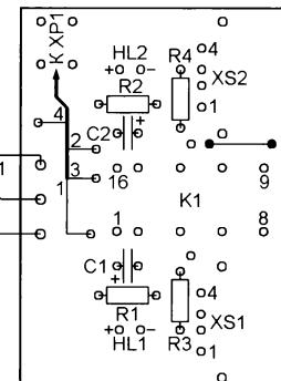
Амплитуда импульсов тока, потребляемого коммутатором по цепи  $V_{bus}$  в моменты переключения, — около 30 мА. В паузах между переключениями ток потребляют только светодиоды HL1 или HL2, сигнализирующие о состоянии коммутатора.
