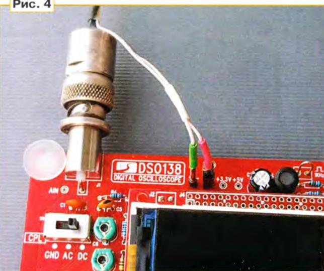
поскольку в случае электрического обратимого пробоя полупроводниковых элементов в составе ОУ эти резисторы ограничивают ток до безопасного уровня. Для экспериментальной проверки на вход щупа подавалось напряжение амплитудой 30 В. Выходной сигнал, ко-
