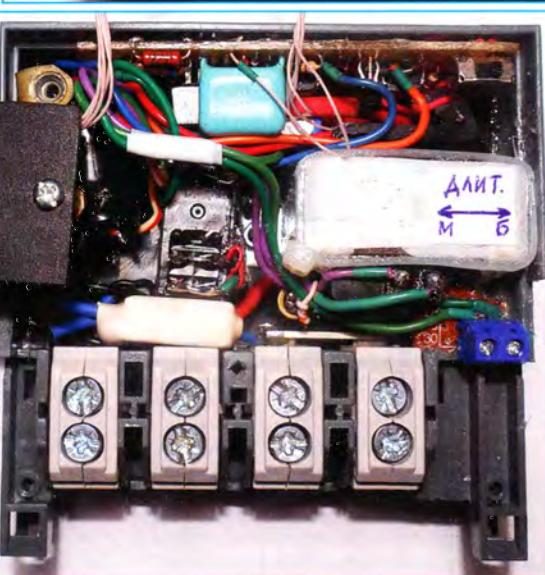
помещён в отрезок термоусаживаемой трубы и размещён в промежутке между корпусом реле и сетевыми клеммами. Светодиоды HL4, HL6, HL7 закреплены с помощью клея в отверстиях пластины из полистирола, которая с помощью стойки высотой 8 мм и винта M3 крепится к металлической пластине, на которой смонтирована микросхема DA1. Вид на монтаж устройства представлен на рис. 5.
