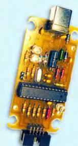
Схема и описание программатора опубликованы в журнале «Радио» № 7 за 2008 г., автор А. Рыжков, г. Новокузнецк. При изготовлении набора были учтены пожелания читателей, и принципиальная схема USB программатора была соответствующим образом доработана. Поэтому удаление «лишних», на первый взгляд, деталей может привести либо к неправильному функционированию программатора, либо к выходу из строя порта USB компьютера.
