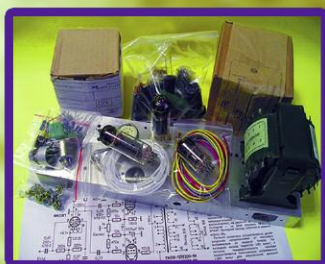
"Двухтактный оконечный усилитель на 6Н23П и 6П43П"
