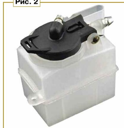
При достаточном количестве масла в бачке контакты датчика его уровня должны быть разомкнуты. В этой ситуации резистор R3 обеспечит на входе GP3 микроконтроллера высокий логический уровень напряжения. Если масла недостаточно, контакты замкнуты, а на входе GP3 установлен низкий уровень.
