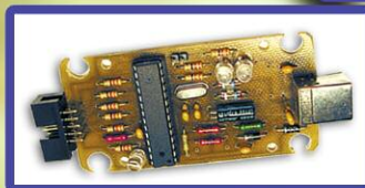
"USB программатор микроконтроллеров AVR и AT89S, совместимый с AVR910"
