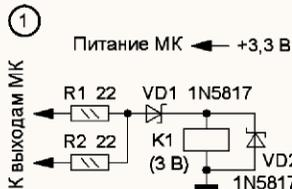
Какие сигналы надо выставлять на выходах МК для включения и выключения реле K1?
