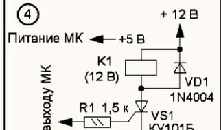
Можно ли импульсом с выхода МК выключить реле K1?
