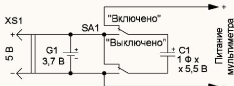
мультиметра и подключает ионистор C1 к аккумулятору для зарядки. В положении "Включено" переключатель подключает ионистор последовательно с аккумулятором, и суммарное (удвоенное) напряжение поступает на мультиметр.
