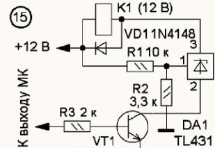
В каком случае стабилизатор DA1 снимает питание с реле K1?
