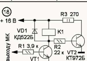
Какое сопротивление обмотки должно быть у реле K1, чтобы потребляемый ток был постоянным?
