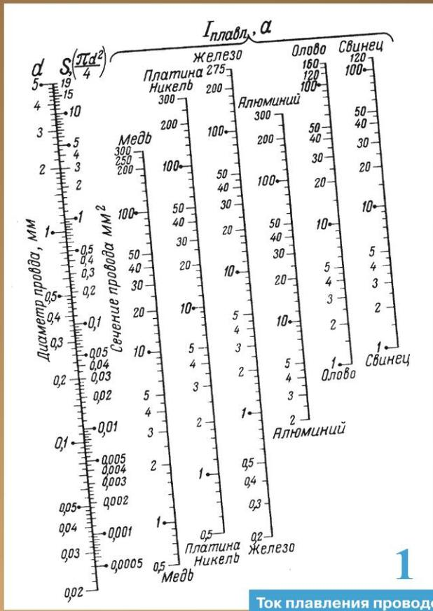
Ток плавления проводов.
