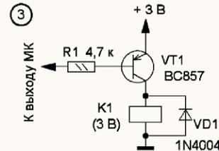
При каком уровне на выходе МК срабатывает реле K1?
