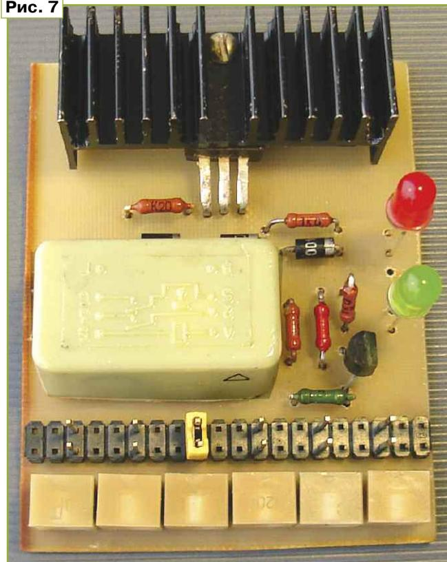
Работает устройство так. После подключения заряжаемой батареи практически весь зарядный ток (250 мА) протекает в неё. Он течёт через диоды VD1—VD3 и падения напряжения на них (около 2 В) достаточно для питания светодиода HL2 красного свечения, который сигнализирует о процессе зарядки. При этом микросхема DA1 и транзистор VT1 закрыты, светодиод HL1 зелёного свечения обесточен. По мере зарядки аккумуляторной батареи напряжение на
