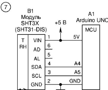
Чем лучше заменить датчик температуры и влажности SHT31-DIS в модуле B1? 0 - датчиком SHT30-DIS; 1 - датчиком SHT35-DIS
