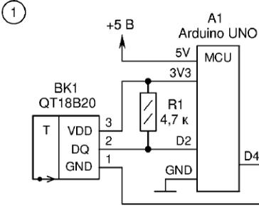
Для чего датчик BK1 запитывается от стабилизатора напряжения 3,3 В Arduino? 0 - для снижения саморазогрева датчика; 1 - для повышения точности измерений
