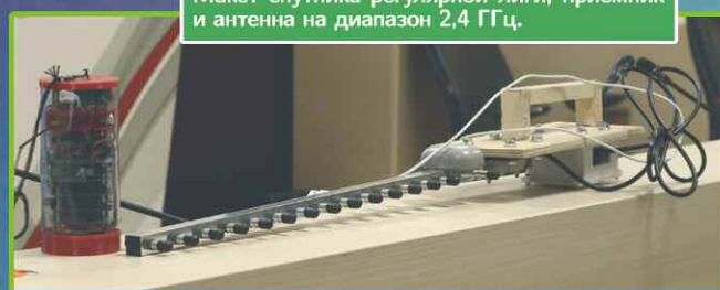
Макет спутника регулярной лиги, приёмник и антенна в диапазон 2,4 ГГц.
