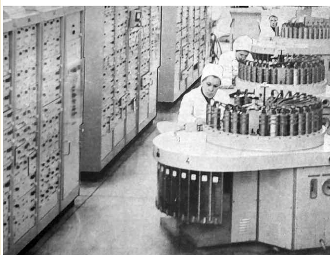
УЧАСТОК СОРТИРОВКИ ГОТОВЫХ ТРАНЗИСТОРОВ НА КЛАССИФИКАТОРАХ КТ2-12
