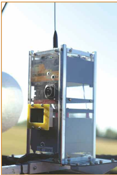
Передатчик Дениса Ефремова для стратосферного аппарата.
