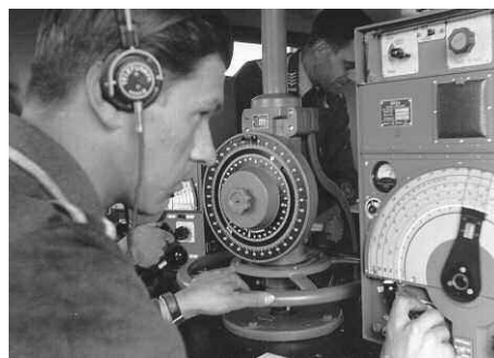
Мобильный вариант пеленгатора выпускался компанией Telefunken с 1938 г. Пеленгатор также использовался в Швейцарии. Тактико-технические характеристики пеленгатора: чувствительность — 1,5...10 мкВ, диапазон частот — 75 кГц...3,33 МГц.
