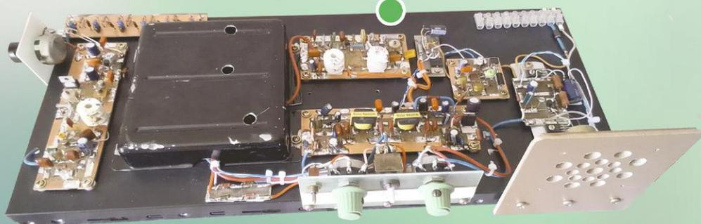
Вид на тракт ПЧ с экранированным узлом А3 со стороны задней панели.
