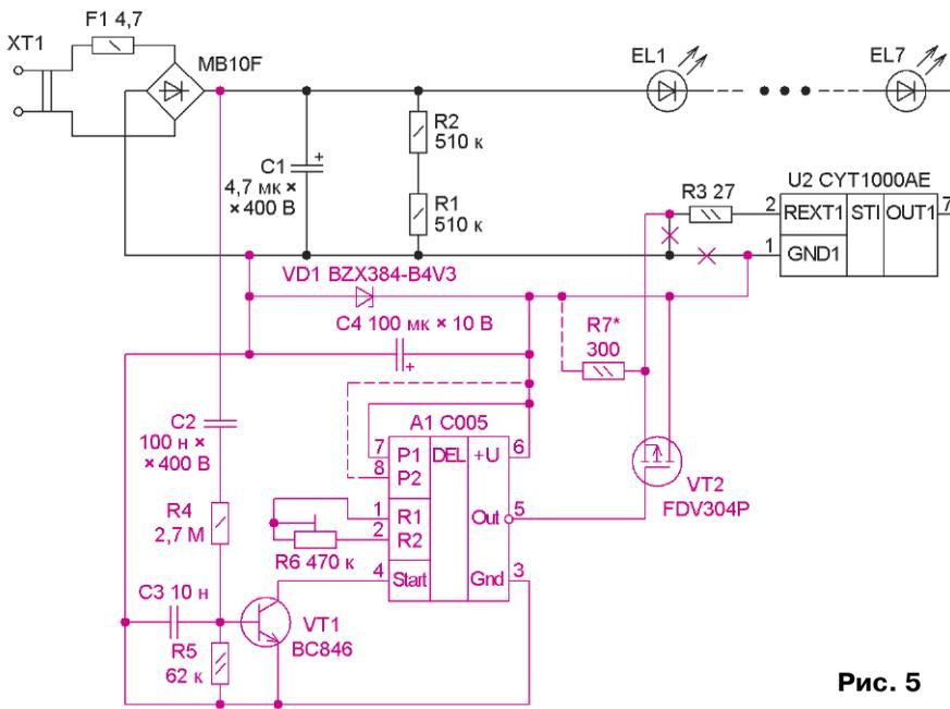
более легкоплавкого припоя. Радиолюбители часто применяют такой способ, чтобы не повредить и не перегреть снимаемые с платы детали. Резистор R3 затем устанавливают на печатную плату таймера. С указанными номиналами элементов продолжительность выдержки — несколько минут.
