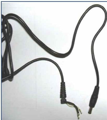
Замыкание было в нём. На основании его осмотра я сделал предположение, что замыкание может быть в месте одного или нескольких перегибов (рисунок). Так и оказалось. От кабеля был отрезан конец с разъёмом подключения к ноутбуку (длина провода 19 см). На этом участке короткого замыкания не было. Затем от оставшейся части кабеля был отрезан участок длиной 36 см. И в этом участке, и в
