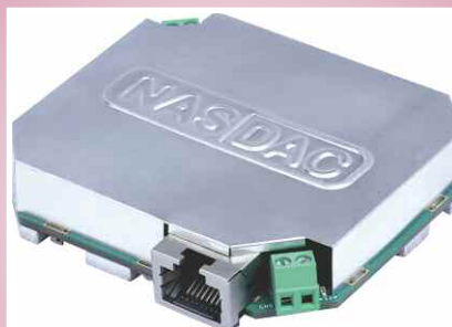
Электронный блок активного сетевого громкоговорителя.
