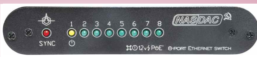
Восьмипортовый сетевой коммутатор.
