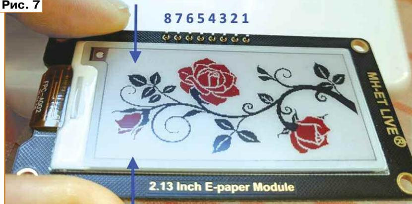
меры 250×128 пикселей, а также расширение файла — **.jpg**. Ключевые настройки обозначены стрелками на рис. 4. Модуль используемого автором экрана (версия 4) имеет три цвета отображения — чёрный, белый и красный. Кроме этого, на плате установлен преобразователь уровней, что позволяет питать модуль от напряжения 5 В или 3,3 В.
