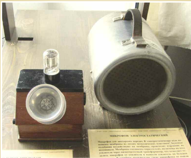
Угольный (слева) и электростатический (конструкция М. А. Бонч-Бруевича и С. И. Шапошникова, 1928 г.) микрофоны. В угольном микрофоне использован однокаскадный усилитель на триоде.
