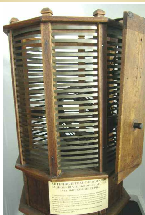
Антенный трансформатор радиовещательной станции "Малый Коминтерн" (подлинник).
