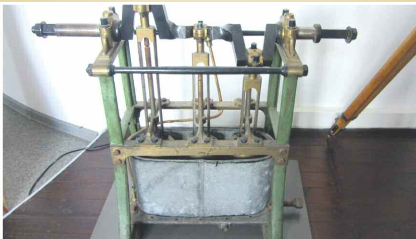
Насос для откачки ламп — водолазная помпа.
