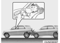
Подушки безопасности не предназначены для срабатывания при задних столкновениях, поскольку в таких случаях водитель и пассажиры смещаются назад. В таком случае подушки безопасности при их раскрытии не смогут обеспечить какой-либо дополнительной защиты.
