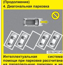
помощи при парковке рассчитана на параллельную парковку и не используется для диагональной парковки. Даже если для автомобиля достаточно места, не используйте интеллектуальную систему помощи при парковке, поскольку она будет выполнять маневры параллельной парковки.
