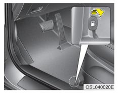
Открытие крышки горловины топливного бака
