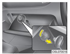
При открытом перчаточном ящике: удалить с обеих сторон стопоры.
