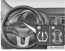
(1) Сигнализатор низкого давления в шинах / Индикатор неисправности системы TPMS
