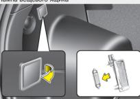
ОЕD076046/ОЕD076047 Лампы освещения подножки двери (при наличии)
