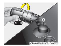
Автоматическое включение осветительных приборов (при наличии)
