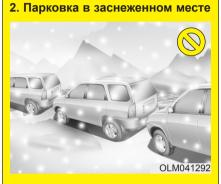
Чувствительность системы может снижаться, в зависимости от величины снежного покрытия. Если при использовании интеллектуальной системы помощи при парковке автомобиль начнет пробуксовывать, систему можно выключить. Если навыки водителя в обращении с педалями акселератора И тормоза не очень развиты, может произойти столкновение.
