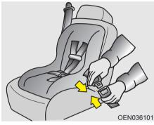
Вставьте язычок замка трехточечного ремня безопасности в пряжку. При соединении должен быть ясно слышан щелчок.
