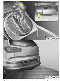
Система контроля мертвой зоны видимости перед автомобилем представляет собой вспомогательную систему, которая предназначается для вывода изображения мертвой зоны видимости перед автомобилем на экран аудиовизуального монитора. Данная система является вспомогательным средством обзора с выводом изображения на дисплей зеркала заднего вида при движении автомобиля задним ходом.
