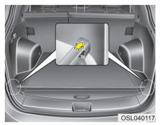
Если защитный экран багажного отделения не используется, разместите его в нижней части багажного отделения.
