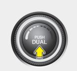
Когда на стороне водителя устанавливается максимальная (HI) или минимальная (Lo) температура для работы в режиме максимального обогрева или охлаждения, двухтемпературный режим регулирования деактивируется.
