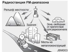
Высокая частота радиосигналов FMдиапазона не позволяет им огибать земную поверхность. Поэтому, как правило, мощность таких радиосигналов падает на коротких расстояниях от передающей радиостанции.
