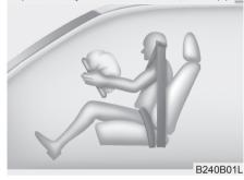
Модули подушек безопасности находятся в центре рулевого колеса и внутри передней панели напротив пассажирского сиденья над перчаточным ящиком. Когда блок SRSM определит наличие удара большой силы в переднюю часть автомобиля, он автоматически подаст команду на раскрытие подушек безопасности. Передняя подушка безопасности водителя (2)
