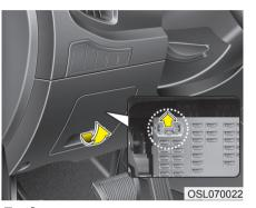
Предохранитель памяти (разъем ШУНТ)
