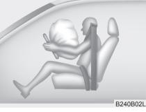
Во время раскрытия давление раскрывающихся подушек вскроет закрывающие их панели по заранее подготовленным местам разрыва. Дальнейшее вскрытие панелей обеспечит наполнение полушек безопасности в полном объеме.
