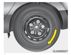
Затем установите ключ в соответствии с рисунком и затяните колесные гайки. Следите, чтобы торцевая насадка плотно обхватывала гайку. Не вставайте на рукоятку ключа и не удлиняйте ее трубой. Пройдите колесо по кругу, затягивая каждую гайку, пока все не будут плотно затянуты.
