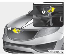
Подойдите к передней части автомобиля, приподнимите капот, потяните за рычаг его блокировки (1), находящийся в центральной части капота, и поднимите капот (2).
