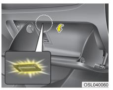
Лампа освещения перчаточного ящика (при наличии)
