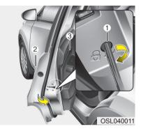
Устройство блокировки замков задних дверей, предотвращающее их открывание детьми
