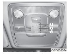
Люк в крыше автомобиля, при его наличии, можно сдвинуть назад или приоткрыть при помощи кнопок управления, которые расположены на потолочной панели.
