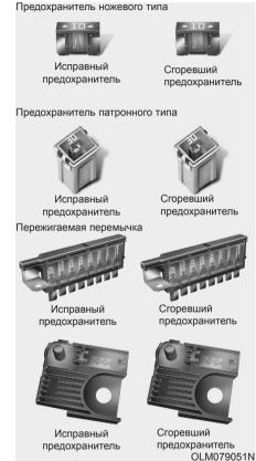
Для защиты электрической системы автомобиля от выхода из строя в результате электрической перегрузки используются плавкие предохранители.
