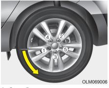
Ослабьте каждую колесную гайку одним оборотом против часовой стрелки, но не откручивайте их до конца до отрыва колеса от земли.
