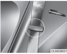
Размещение ремней безопасности внутри направляющих поможет предотвратить защемление ремня за сиденьем или под ним.
