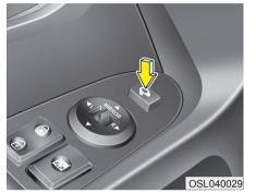
Зеркала с электроприводом складывания (при наличии) Чтобы сложить наружное зеркало заднего вида, нажмите на кнопку. Для его раскладывания нажмите кнопку еще раз.
