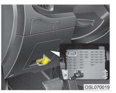
Замена предохранителя, установленного на внутренней панели
