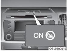
Индикатор включения передней подушки безопасности пассажира (при наличии)
