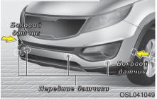
Система помощи при парковке предназначена для звукового или визуального (индикатор) предупреждения водителя о препятствиях, определяемых передними, задними и боковыми датчиками в пределах их рабочей зоны при перемещении автомобиля назад или вперед. Данная система является исключительно вспомогательной. При ее применении водитель должен попрежнему быть внимательным и соблюдать предельную осторожность. Диапазон обнаружения объектов и тип объектов являются ограниченными.
