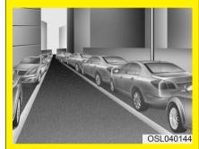
Если места для парковки недостаточно, система поиска места может не функционировать на узкой дороге. Однако даже если система поиска места функционирует, следует быть осторожным.
