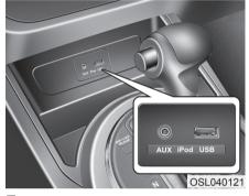
Порты: для дополнительных устройств, USB и iPod (при наличии)
