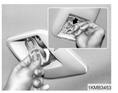
Вставьте пластину с язычком в отверстие в крышке узла ремня.
