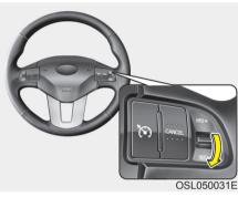
3.Нажмите выключатель SET- и отпустите его на нужной скорости. На приборной панели загорится контрольная лампа SET (Установка). Одновременно с этим отпустите педаль газа. Желаемая скорость будет поддерживаться автоматически.
