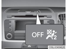
Индикатор отключения передней подушки безопасности пассажира (при наличии)
