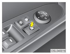
Кнопка блокировки электрических стеклоподъемников
