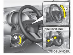
Для изменения угла наклона рулевого колеса потяните вниз рычаг блокировки рулевой колонки (1), установите рулевое колесо на требуемый угол (2) и высоту (3, при наличии), после чего потяните вверх рычаг блокировки рулевой колонки для фиксации рулевого колеса в этом положении. Перед началом движения убедитесь в том, что рулевое колесо находится в необходимом положении.
