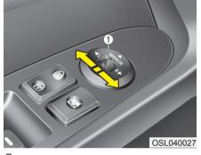
Дистанционное управление Переключатель дистанционного управления положением зеркал заднего вида позволяет настроить углы установки правого и левого наружных зеркал заднего вида. Для регулировки положения любого из зеркал переместите рычажок (1) в положение R или L для выбора правого или левого зеркала соответственно, затем нажмите соответствующую точку на органе настройки зеркала для перемещения выбранного зеркала вверх. вниз. вправо или влево.
