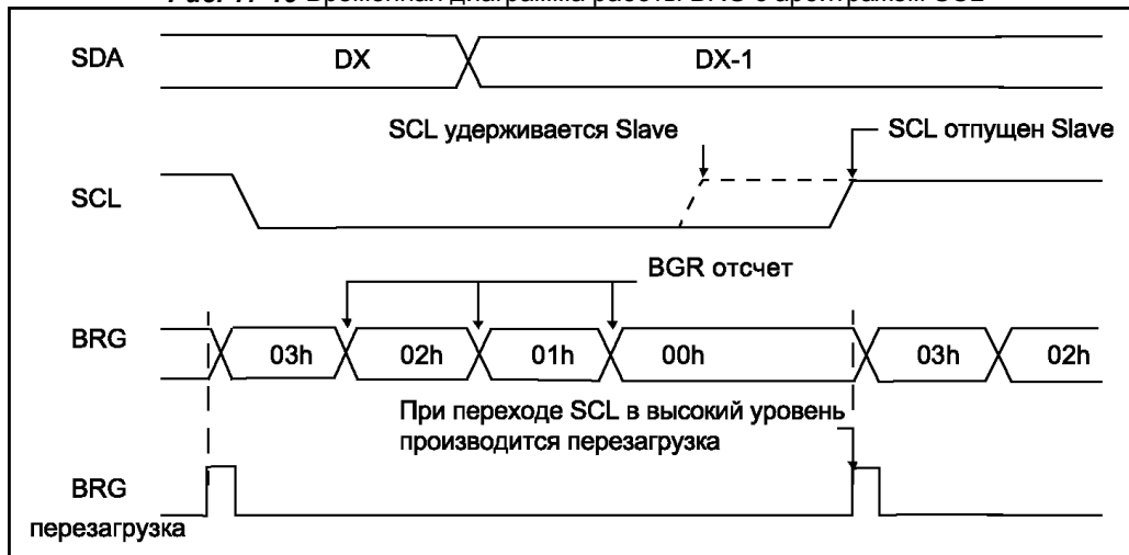
Рис. 17-19 Временная диаграмма работы BRG с арбитражем SCL
