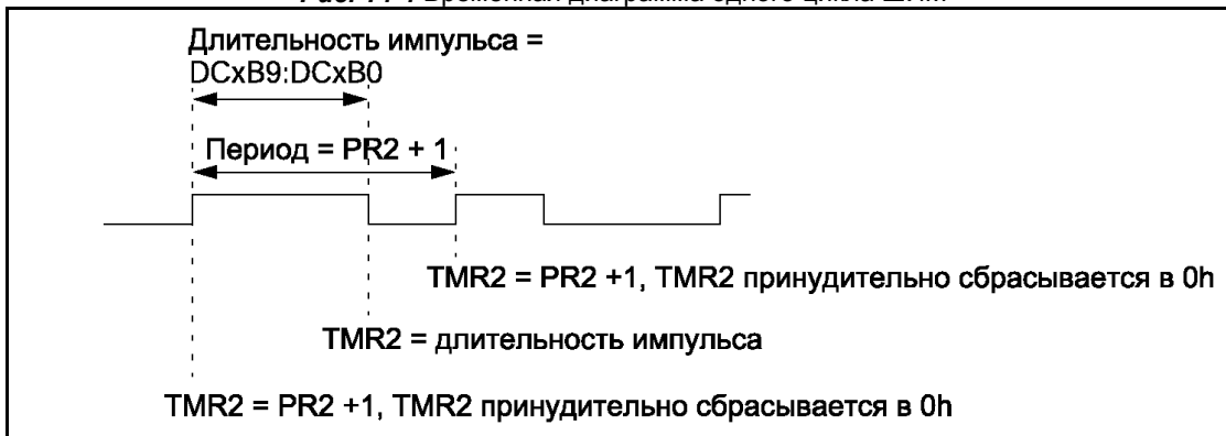
Рис. 14-4 Временная диаграмма одного цикла ШИМ
