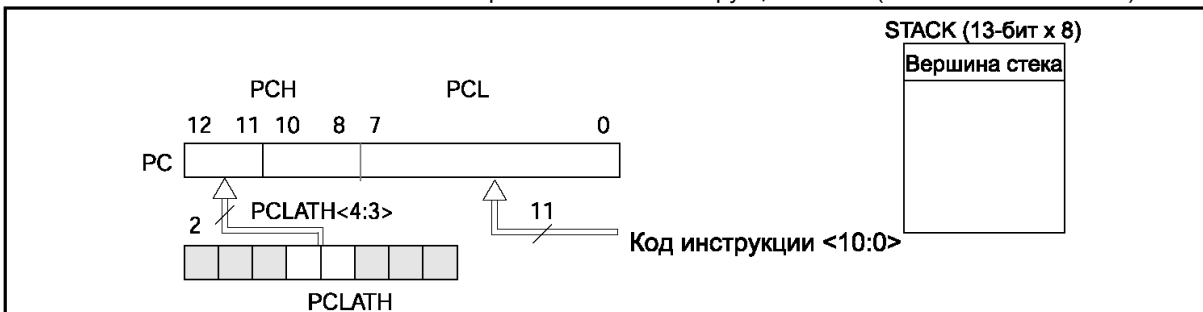
Рис. 6-2б Изменение значения PC при выполнении инструкции GOTO (PCLATH<4:3> → PCH)
