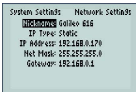
Установка IP адреса на процессоре.
