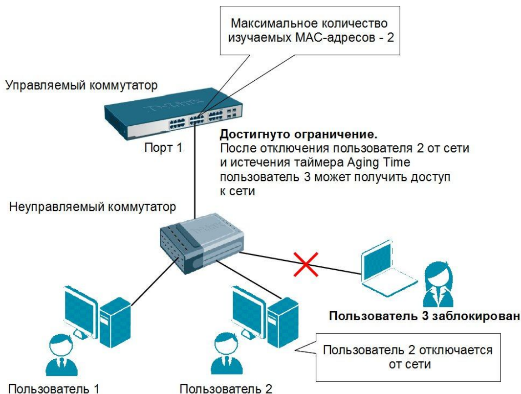
Рис. 8.7. Функция Port Security в режиме Delete on Timeout
