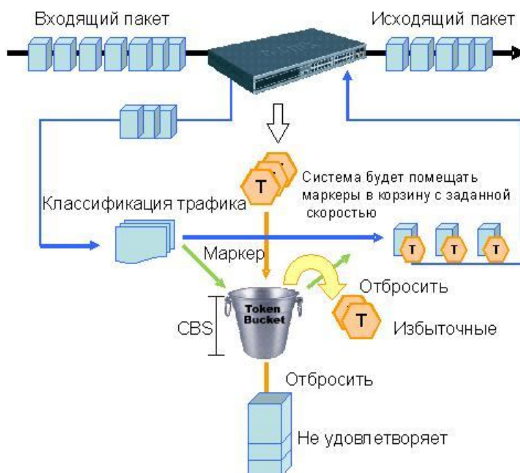
Рис. 7.9. Алгоритм «корзина маркеров» в рамках механизма Traffic Policing
